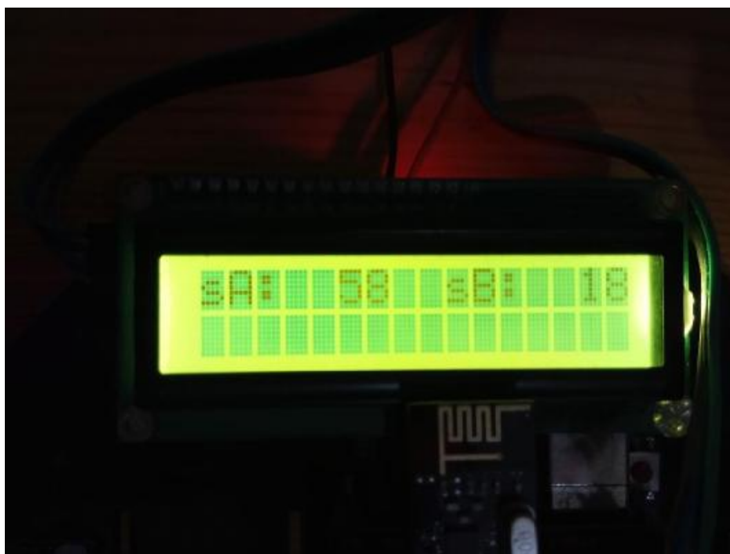
Εικόνα 48: Εμφάνιση δεδομένων 2 σερβοκινητήρων και έλεγχος τους (Ιδία λήψη, 2017).
