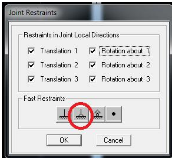
Σχήμα 3.6 Καθορισμός των στηρίξεων του φορέα στο πρόγραμμα SAP 2000.
