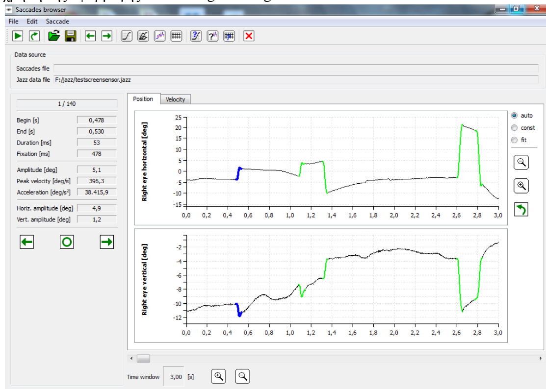
Εικόνα 3.15.: το παράθυρο διαλόγου Saccades Browser για τα σήματα της θέσης της κίνησης των ματιών σε οριζόντιο και κατακόρυφο άξονα της πρώτης σακκάδας.
