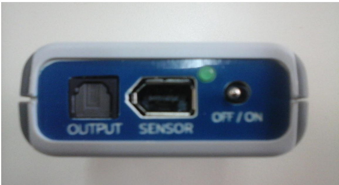
Εικόνα 1.1.β : Κεντρική μονάδα, υποδοχές καλωδίων οπτικής ίνας (output), καλωδίου του πολυαισθητήρα, ένδειξη LED και κουμπί ON/OFF.
