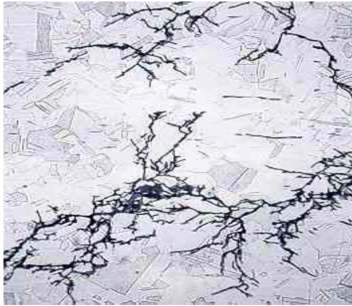
Εικόνα 11: Παράδειγμα διάβρωσης υπο μηχανική τάση 12
