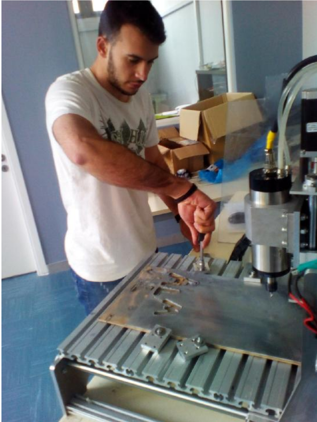
Εικόνα 20: Πρόσδεση προπλάσματος στην τράπεζα της εργαλειομηχανής
