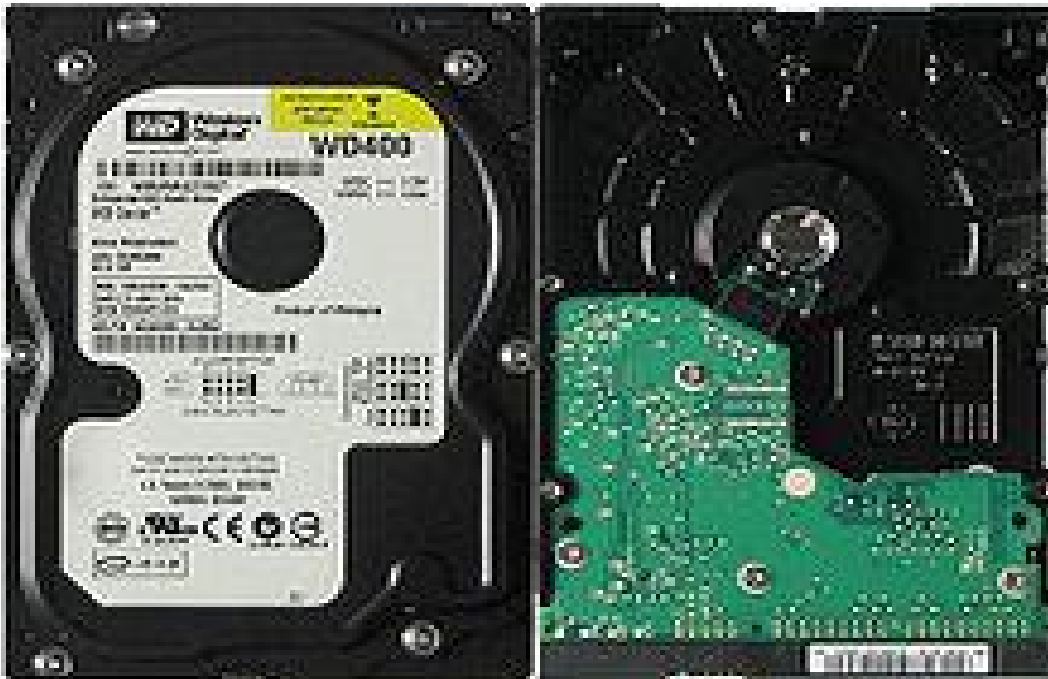
Εικόνα 1: Οι πάνω και κάτω όψεις ενός σκληρού δίσκου (HDD) 3.5"
