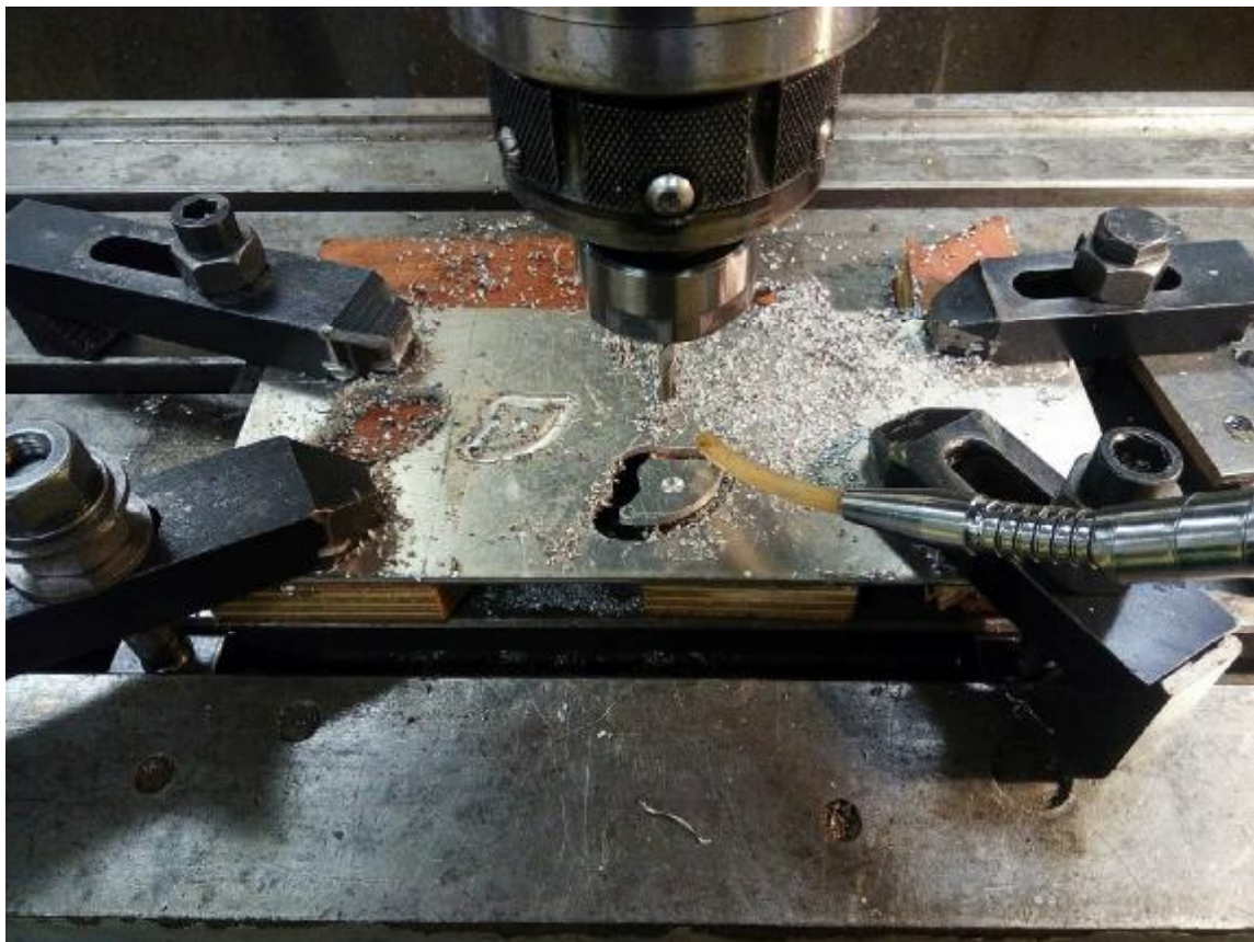
Εικόνα 22: Ολοκλήρωση κοπής στη φρέζα
