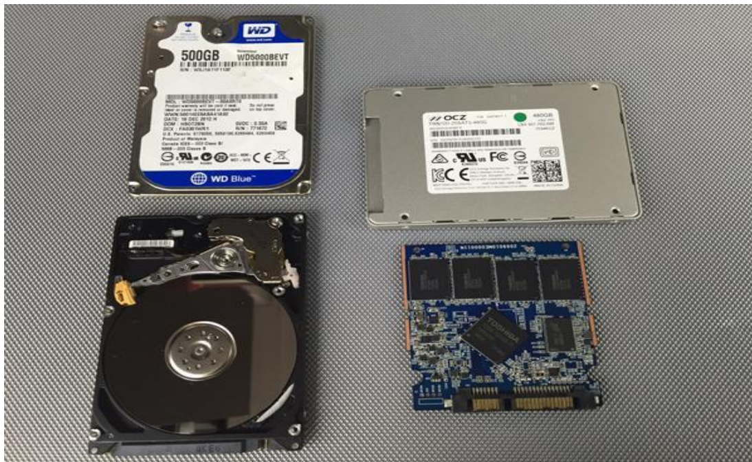
Εικόνα 4: Εσωτερικές όψεις δύο διαφορετικής τεχνολογίας σκληρών δίσκων (HDD – αριστερά και SSD – δεξιά)
