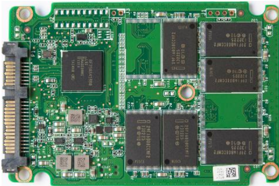
Εικόνα 3 Σκληρός δίσκος στερεάς κατάστασης χωρίς καπάκια προστασίας
