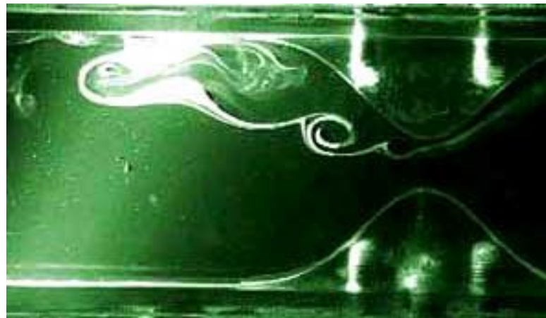
Εικόνα 18 Οπτικοποίηση της αποκόλλησης ροής σε στένωση
