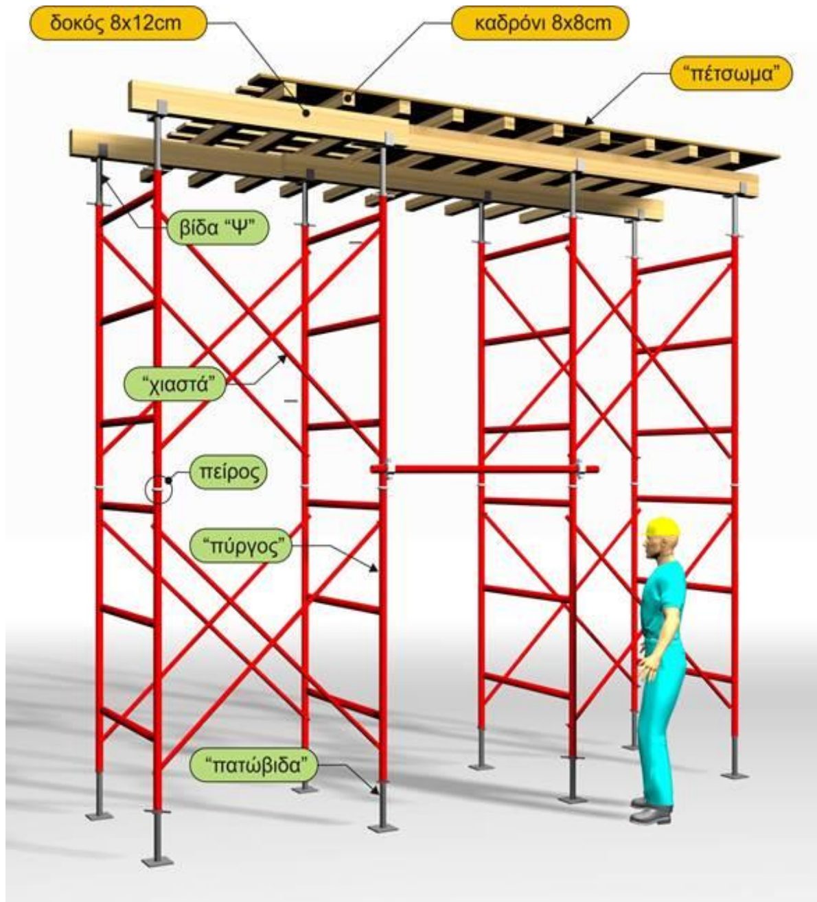
Εικόνα 4-Μέρη ξυλότυπου και ικριωμάτων (διδασκτική πηγή 5)
