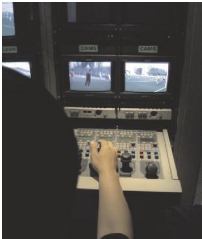
Εικόνα 3-8 Χειριστής βίντεο ρυθμίζει μια κάμερα που είναι μέρος μιας multicamera παραγωγής χρησιμοποιώντας μια CCU (πηγή Millerson)
