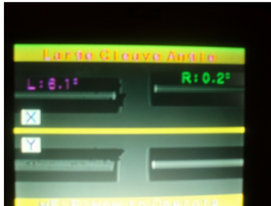
Εικόνα 54. Μήνυμα λάθους λόγω φθοράς στο μανδύα του pigtail(μεγάλη γωνία κοπής)
