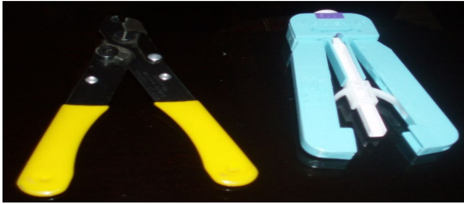
Εικόνα 52. Ειδικοί απογυμνωτές rigtail και ίνας
