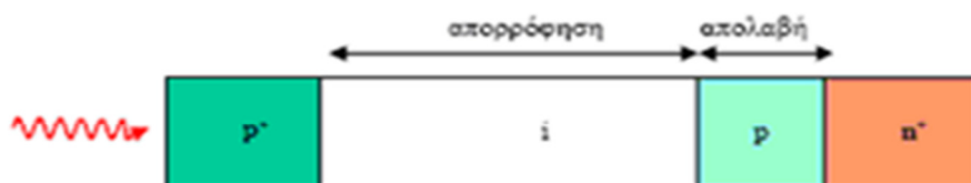
Εικόνα 23.Σχηματική διάταξη της δομής μιας τυπικής APD
