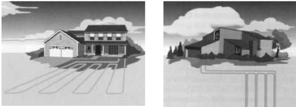
Εικόνα 54-Οριζόντιος και Κάθετος Γεωεναλλάκτης
