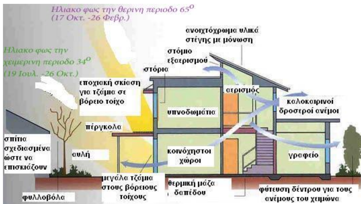
Εικόνα 3-Τομή Κτιρίου Κατοικίας
