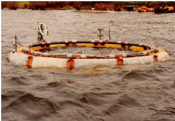
Εικόνα 32. Πειραματική κατασκευή sea clam στο Loch Ness (Πηγή : seaclam.co.uk )
