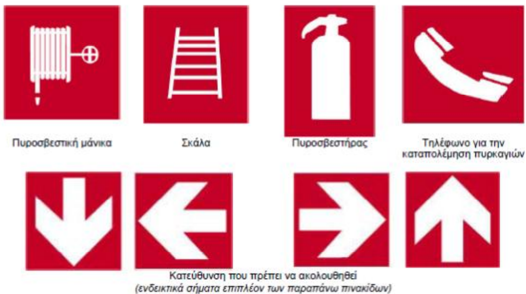
Εικόνα 18. Πινακίδες που αφορούν το πυροσβεστικό υλικό ή εξοπλισμό
