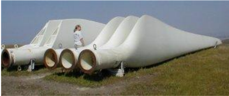
Εικόνα 3.7: Πτερύγια ανεμογεννήτριας με μήκος περίπου 15 μέτρα.
