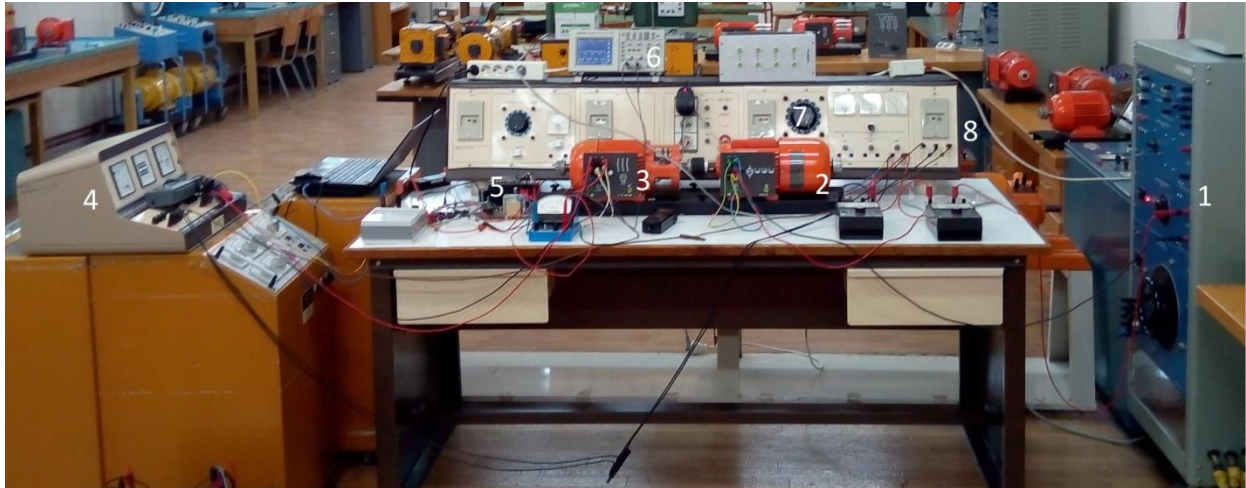
Σχήμα 7.5: Πειραματική διάταξη. 1) Τροφοδοτικό συνεχούς ρεύματος. 2) Κινητήρας συνεχούς ρεύματος. 3) Σύγχρονη γεννήτρια. 4) Συσκευή συγχρονισμού με δίκτυο χαμηλής τάσης. 5) Μετατροπέας με την παλμοδότηση. 6) Παλμογράφος. 7) Μεταβαλλόμενη πηγή εναλλασσόμενου ρεύματος (Variac). 8) Τριφασικό δίκτυο χαμηλής τάσης.
