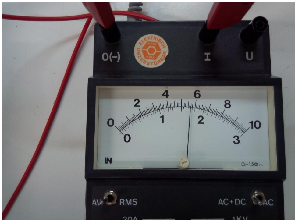
Σχήμα 7.15: Ένδειξη ρεύματος κινητήρα συνεχούς 5,55 A
