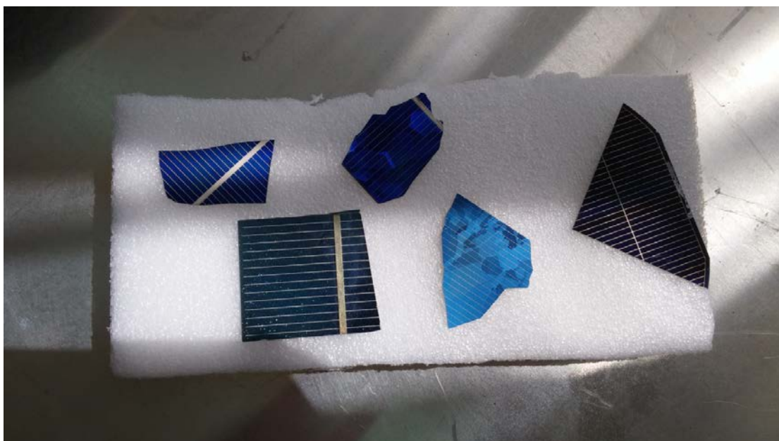
Εικόνα 2.14: Τμήματα μονοκρυσταλλικών και πολυκρυσταλλικών στοιχείων, διακρίνεται το επάργυρο μέρος busbar όπου αυτό είναι ο αγωγός όπου τα ηλεκτρόνια οδηγούνται στην έξοδο και επίσης διακρίνονται και τα fingers 20
