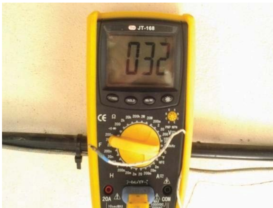
Εικόνα 5.12 : Καταγραφή θερμοκρασίας δωματίου του οικίσκου με χρήση πολυμέτρου
