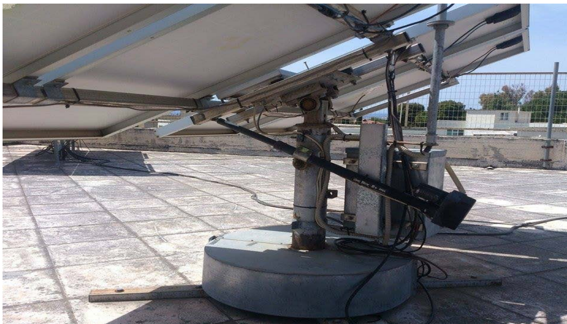
Εικόνα 2.41: Διαξονική κινητή βάση παρακολουθήσεις του ηλιακού δίσκου, εργαστήριο ΑΠΕ, ΤΕΙ Δυτικής Ελλάδας
