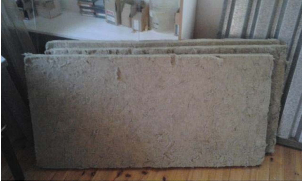
Εικόνα 5.16 : Μόνωση συλλέκτη στέγης οικίσκου
