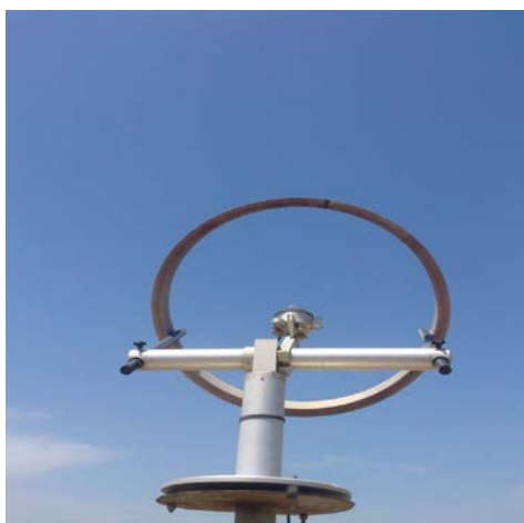
Εικόνα 1.24: Πυρανόμετρο με στεφάνι τοποθετημένο στο εργαστήριο των ΑΠΕ, ΤΕΙ Δυτικής Ελλάδας
