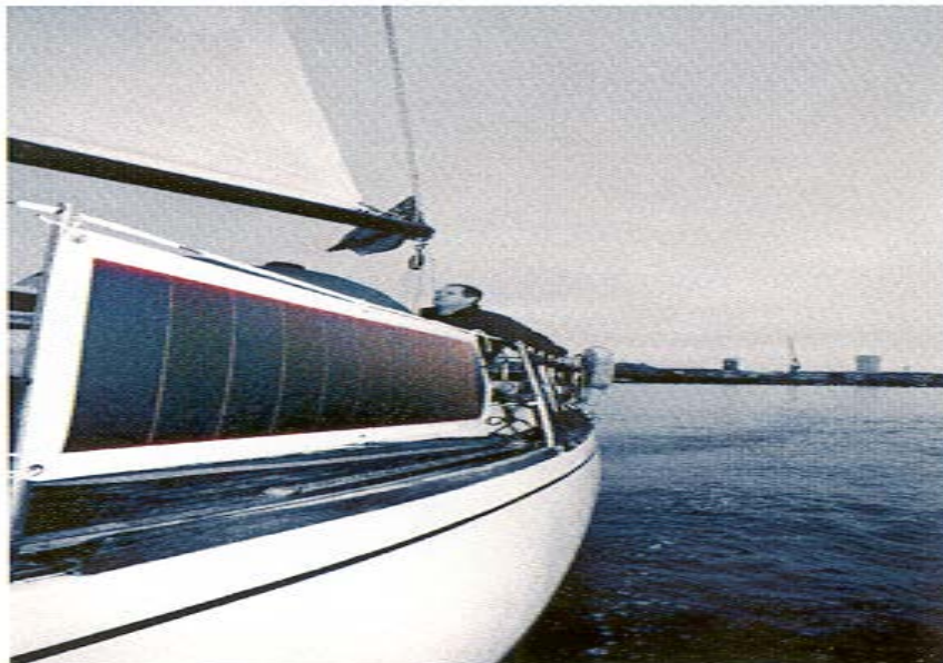
Εικόνα 2.3: PV-γεννήτρια με PV στοιχεία τεχνολογίας λεπτού υμενίου. Τα στοιχεία είναι λεπτά, ελαφρά και ευλύγιστα και προσαρμόζονται εύκολα ακόμα και σε καμπύλες επιφάνειες όπως π.χ. πλοiάρια, οχήματα κλπ.
