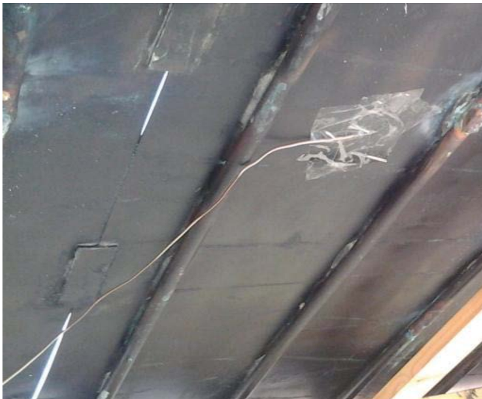
Εικόνα 5.10 : Τοποθέτηση θερμοζεύγους στην συλλεκτική επιφάνεια
