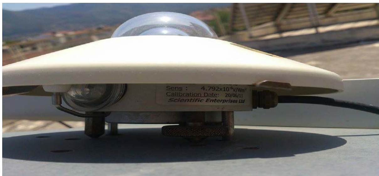
Εικόνα 1.22: Πυρανόμετρο τοποθετημένο στην σταθερή Φωτοβολταϊκή γεννήτρια (Fixed) στο εργαστήριο των ΑΠΕ, ΤΕΙ Δυτικής Ελλάδας
