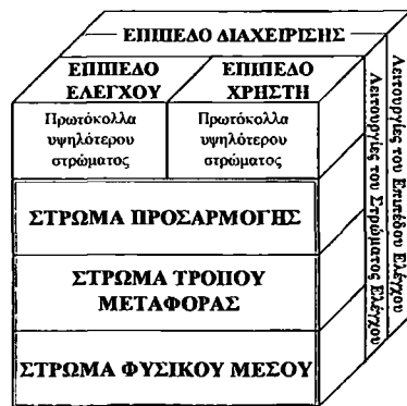
Σχήμα 2: Το μοντέλο αναφοράς του πρωτοκόλλου B-ISDN
