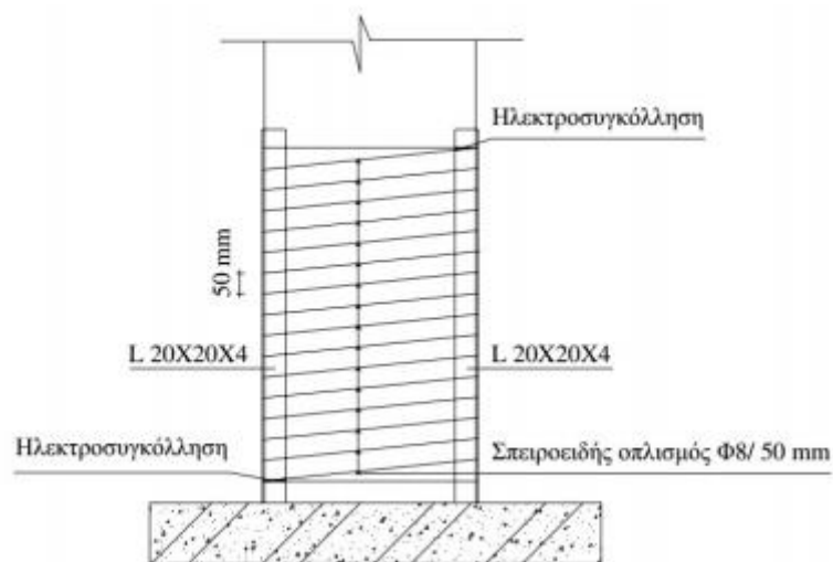
Σχήμα 2.3: Περίσφιγξη με σπειροειδή σπλισμό (Παναγόπουλος Γ.)
