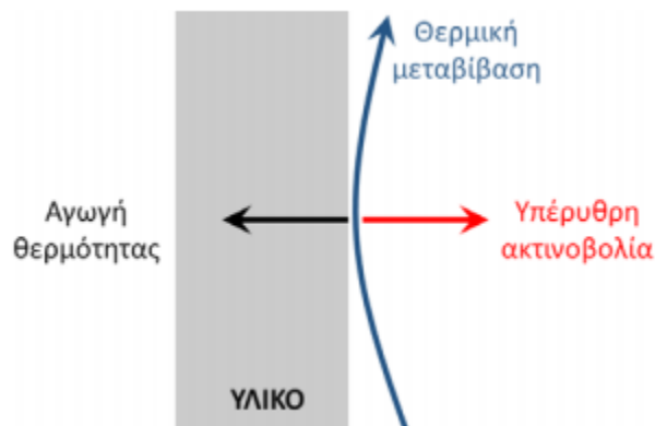
Σχήμα 12: Μηχανισμοί διάδοσης θερμότητας για ένα υλικό.
