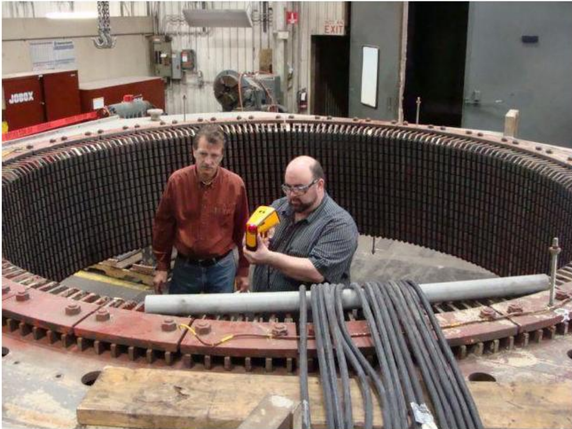
Εικόνα 28 :Θερμογραφικός έλεγχος για εντοπισμό ελαττωματικών μονώσεων
