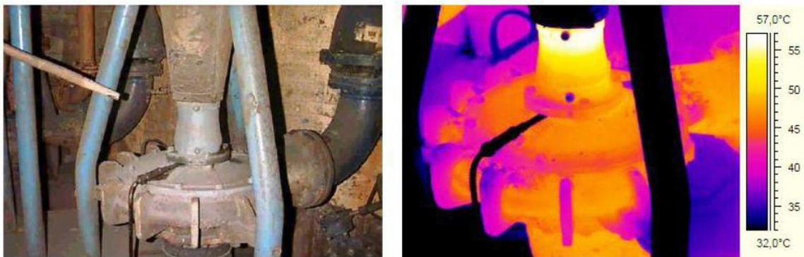
Εικόνα 16: Φωτογραφία και θερμική εικόνα ύποπτου ρουλεμάν αντλίας
