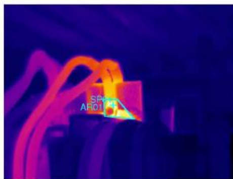
Εικόνα 20: Χαλαρή σύνδεση καλωδίων
