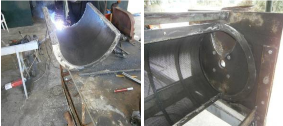
Εικόνα 53: Αρχικά στάδια κατασκευής του τυμπάνου.
