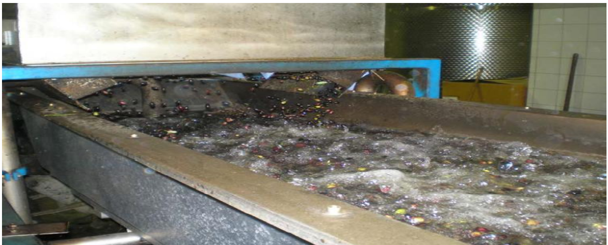
Εικόνα 4: Διαδικασία πλύσης του καρπού μετά το διαχωρισμό από τα φύλλα [1].
