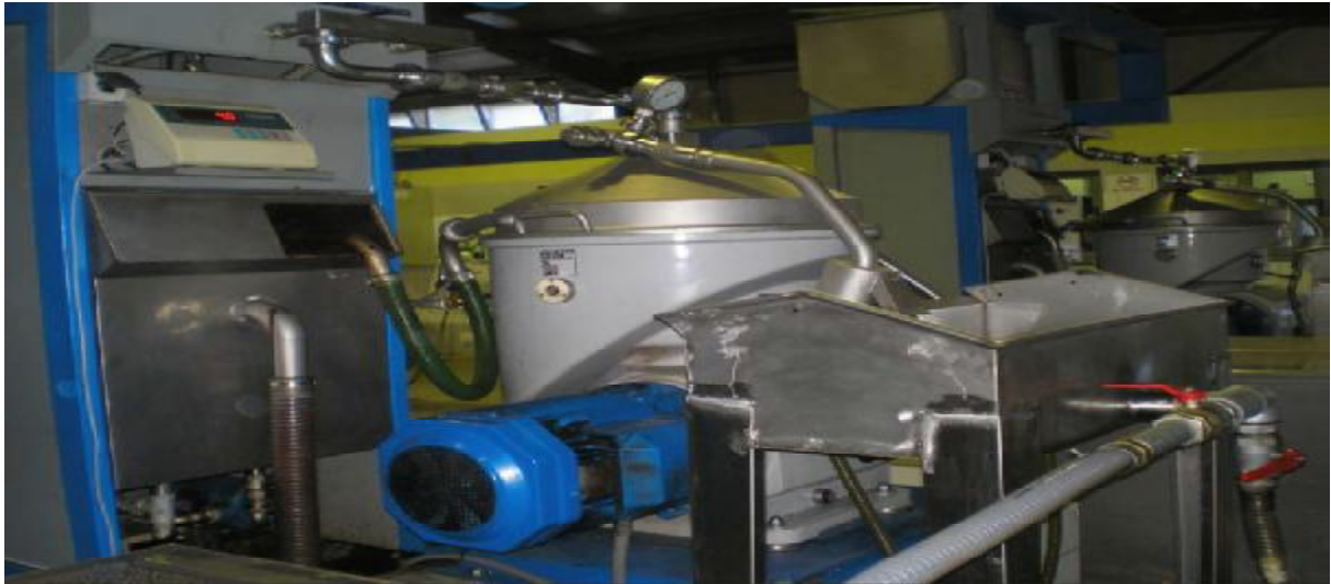
Εικόνα 12: Τελικός διαχωρισμός του λαδιού από το νερό [1].
