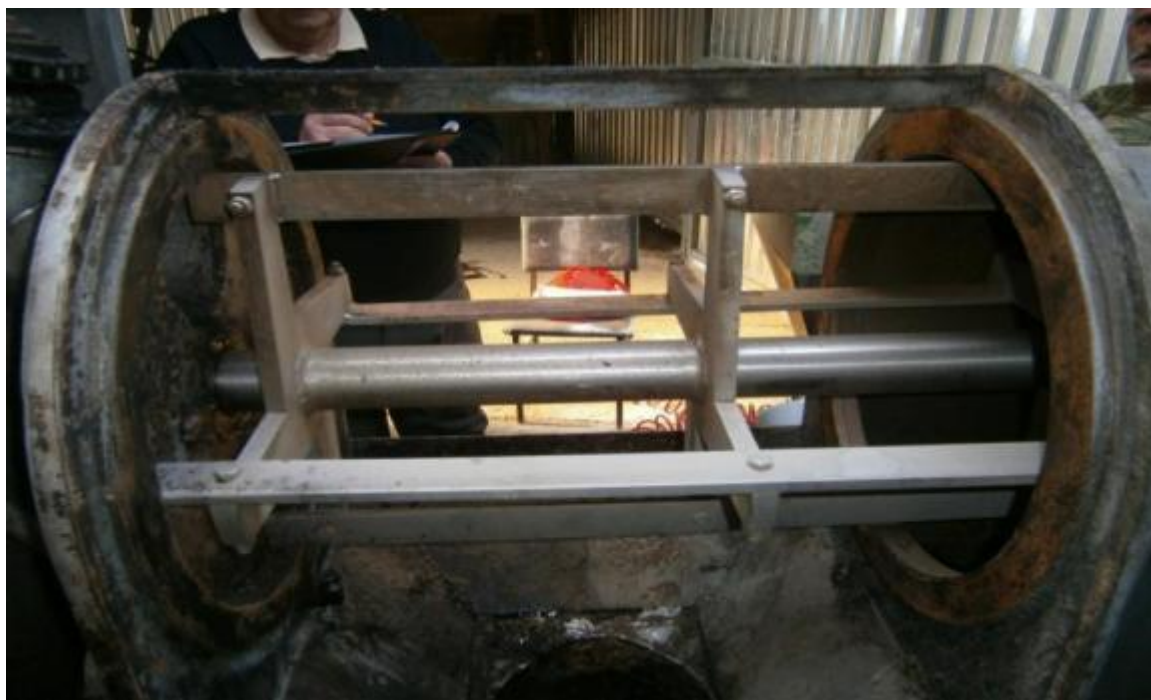
Εικόνα 57: Τελικό στάδιο κατασκευής της άτρακτου.
