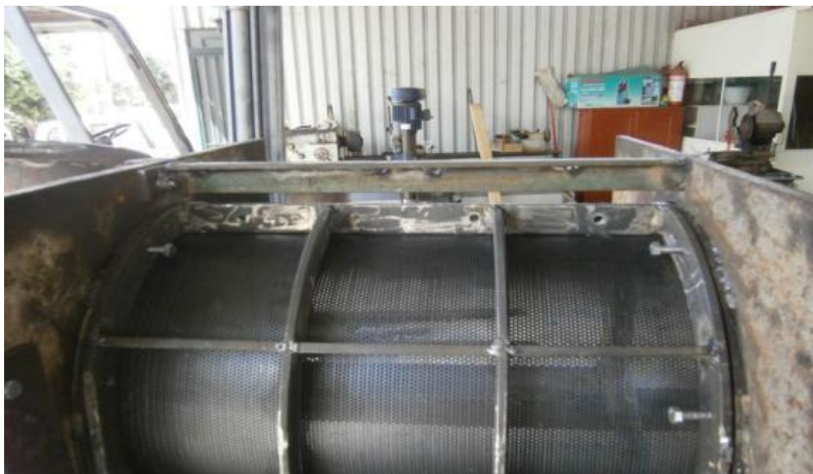
Εικόνα 55: Κατασκευή ενισχύσεων έδρασης διάτρητης λαμαρίνας - τυμπάνου.
