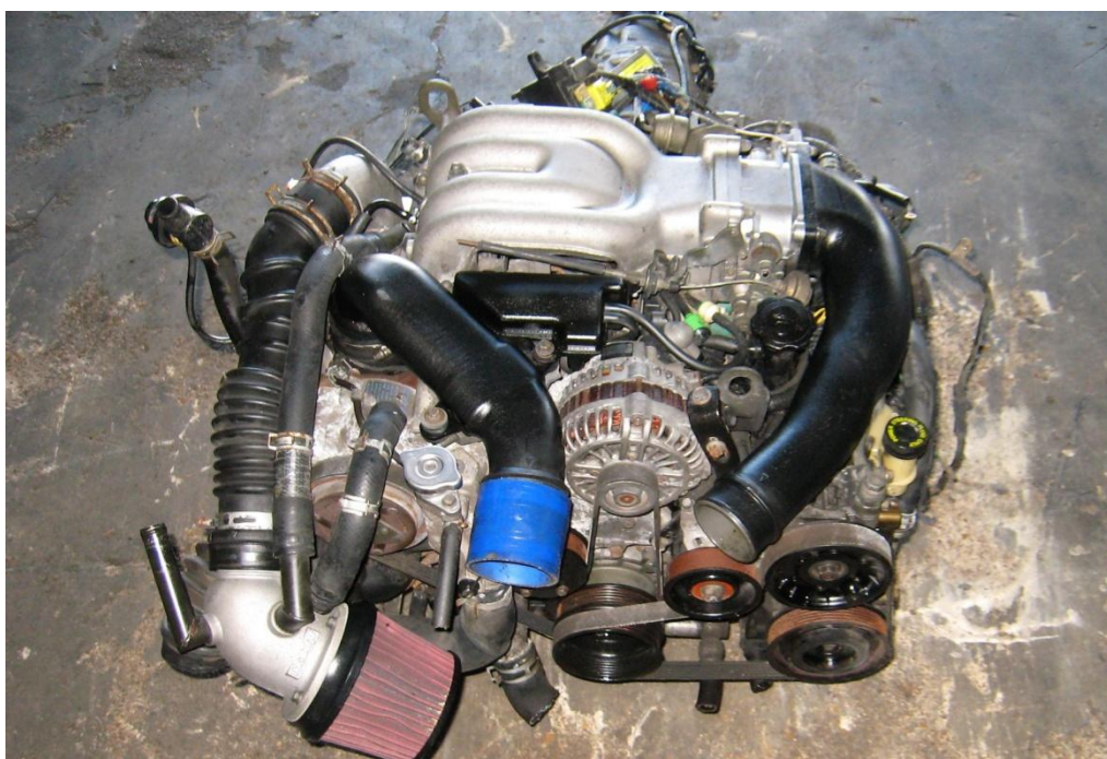
Εικόνα 17 Κινητήρας Mazda 13B-REW twin-turbocharged
