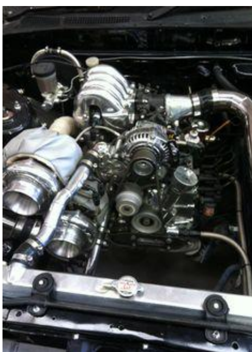
Εικόνα 15 Κινητήρας Mazda 13B-T twin turbo
