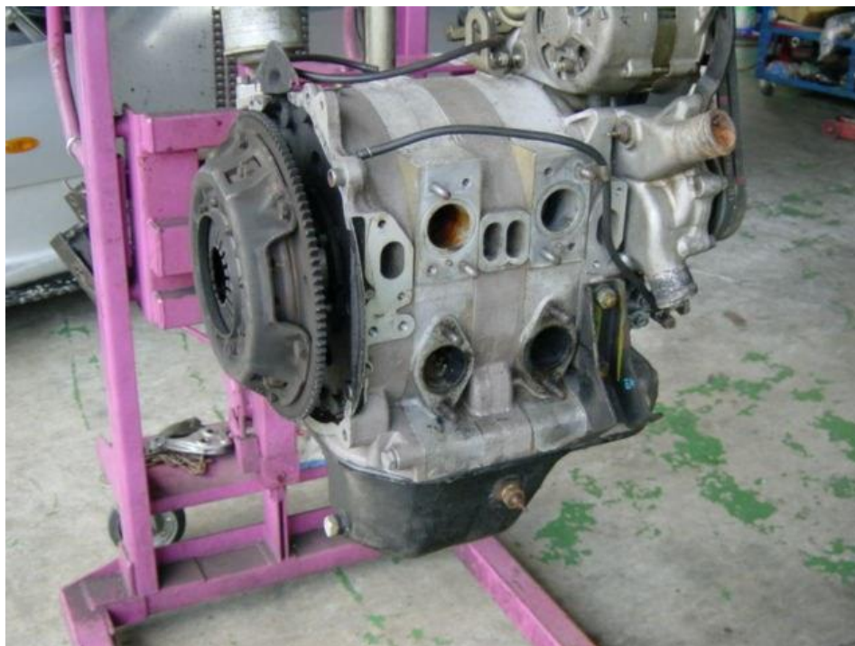
Εικόνα 11 Κινητήρας Mazda 10A - 0866 RX-3
