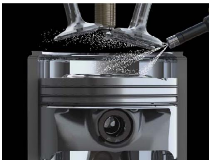
Εικόνα 42 Σχηματική απεικόνιση του συστήματος καύσης 3,5-L V6 EcoBoost με έγχυση GDi πολλαπλών αγωγών
