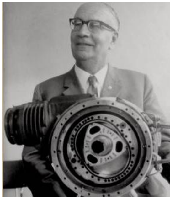
Εικόνα 2 Ο Γερμανός μηχανικός Wankel και η μηχανή που δημιούργησε
