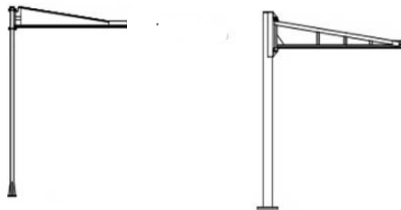
Εικόνα 1.6: Γερανοί σταθμού εργασίας τοποθετημένοι σε στύλο
