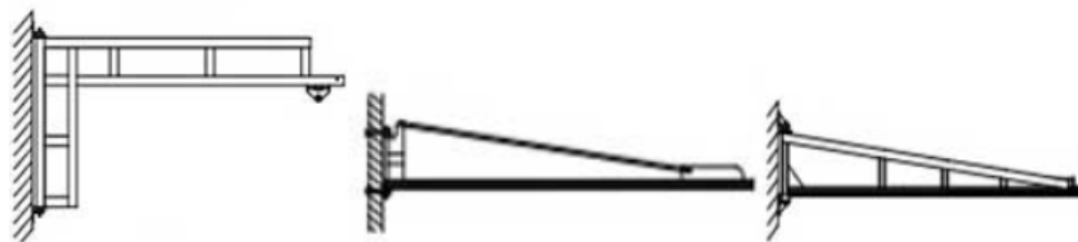
Εικόνα 1.7: Γερανοί σταθμού εργασίας τοποθετημένοι στον τοίχο
