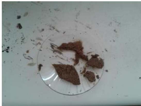
Εικ.2.2.7 Υποδοχέας με δείγμα από μπεντονίτη που περιέχει ποσότητα νερού
