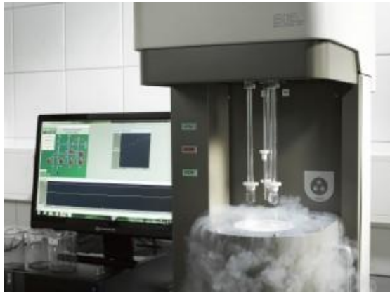
Εικ.2.2.8 Το μαθηματικό μοντέλο χρησιμοποιεί ισοθερμική προσρόφηση αζώτου σε χαμηλή θερμοκρασία
