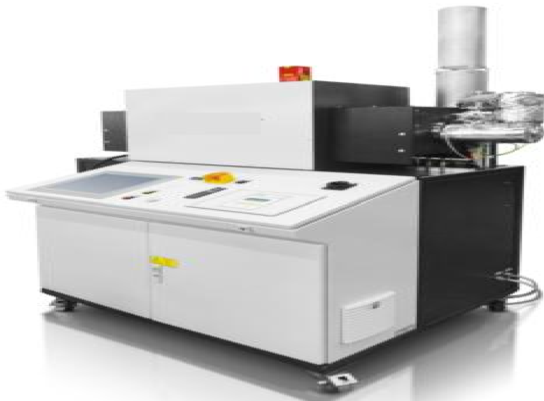
Εικόνα 71: Φούρνος σωλήνα με σύστημα καυσαερίων υδρογόνου.
