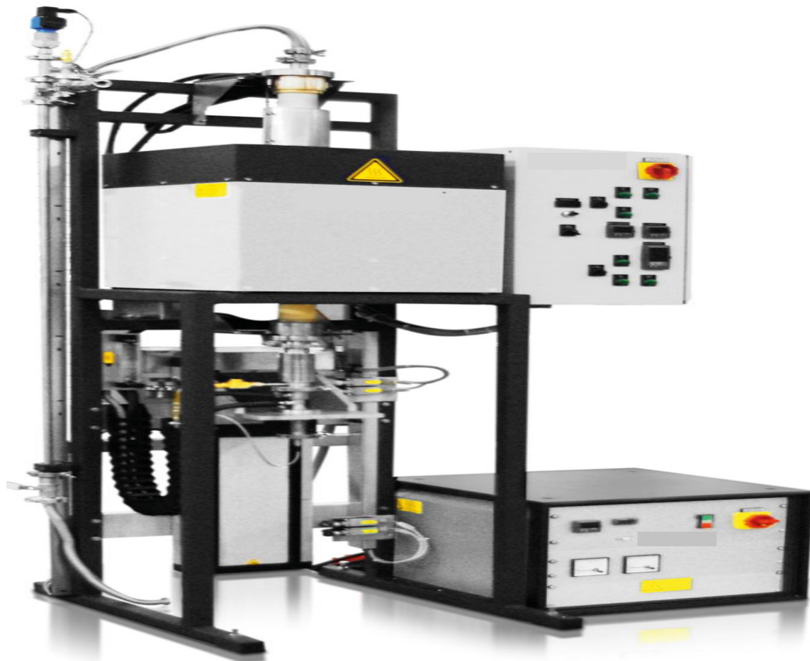
Εικόνα 40: Στην εικόνα παρουσιάζεται φούρνος που χρησιμοποιεί την διαδικασία κρυσταλλικής ανάπτυξης Bridgman.
