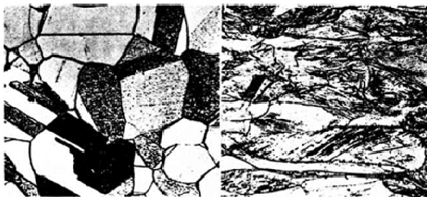
Εικόνα 80: Μεταβολή του κρυσταλλικού ιστού του μετάλλου κατά την ψυχρηλασία, σχηματική παράσταση και μικρογραφία.
