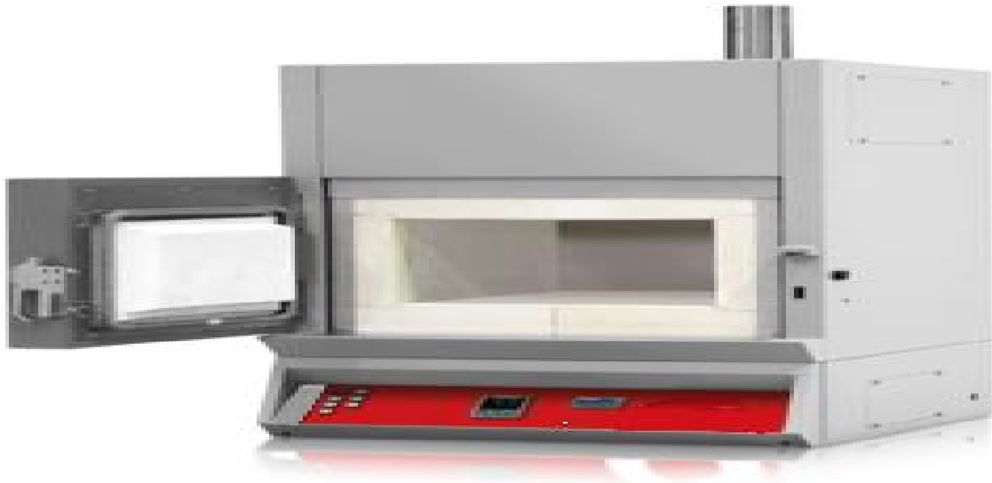
Εικόνα 51: Στην εικόνα παρουσιάζεται ένας φούρνος μετάκαυσης.
