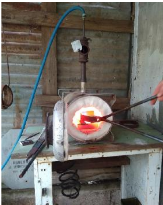
Εικόνα 99: Το καμίνι σε πλήρη λειτουργία με ανοιχτό το πορτάκι, όπου τοποθετείται το υλικό μας για θερμική επεξεργασία.
