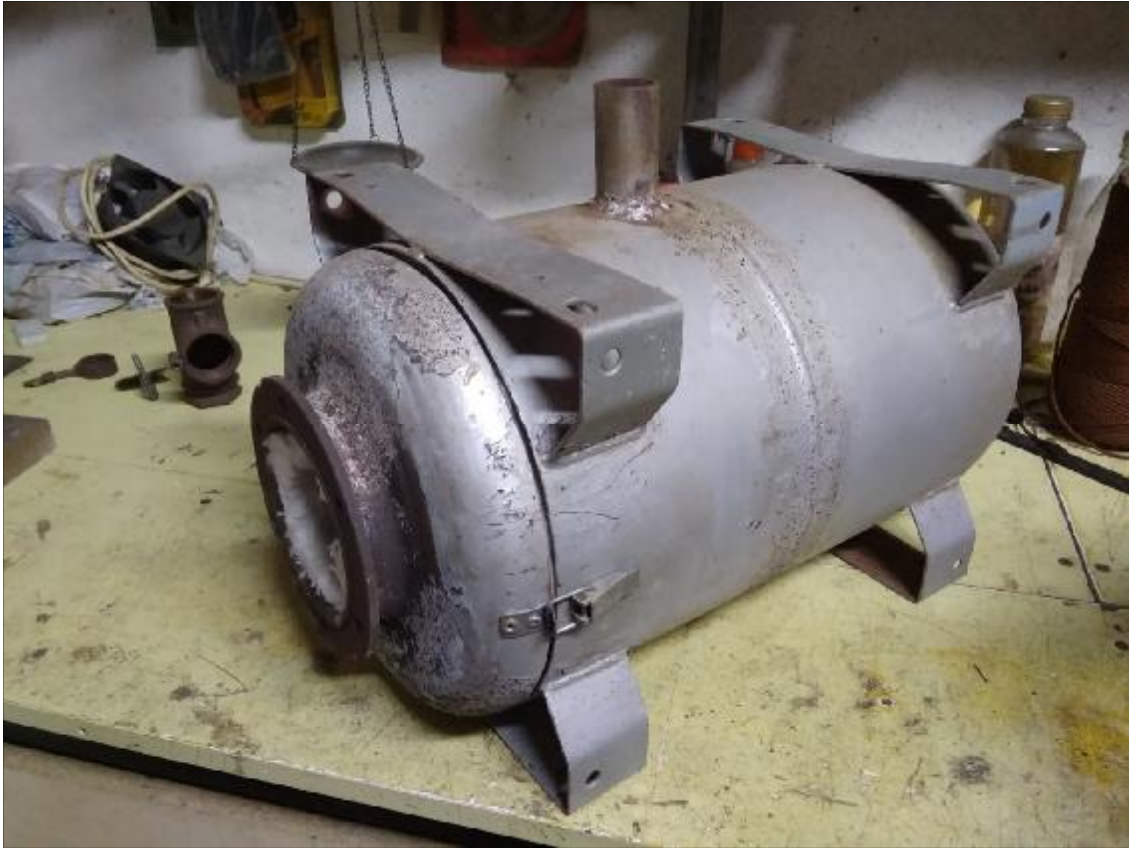
Εικόνα 93: Στην εικόνα παρουσιάζεται η τομή για το πορτάκι εισόδου των τεμαχίων.
