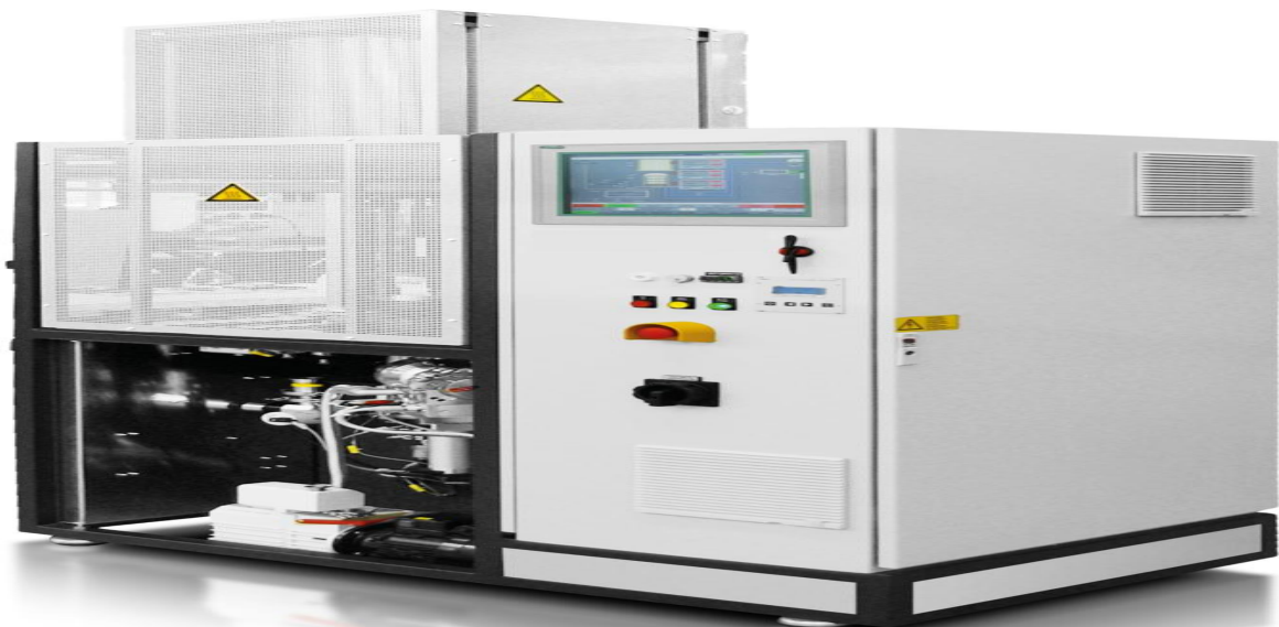
Εικόνα 41 : Στην εικόνα παρουσιάζεται φούρνος συγκόλλησης σωληνών V-L που ανήκει στην κατηγορία των φούρνων με κουκούλα.
