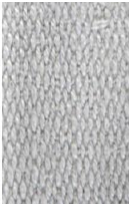
Εικόνα 76: Στην εικόνα αριστερά παρουσιάζεται ένα πυρίμαχο θερμομονωτικό φύλλο από ίνες αμιάντου και κεραμικού ενώ δεξιά παρουσιάζεται θερμομονωτικό ύφασμα από κεραμικές ίνες και ίνες γυαλιού.
