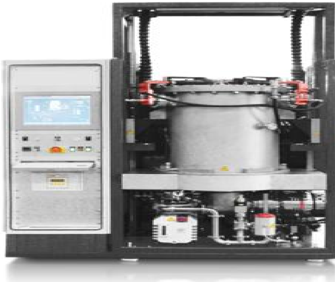
Εικόνα 42: Στην εικόνα παρουσιάζεται ένας εξολοκλήρου μεταλλικός φούρνος με κουκούλα που ανήκει στην κατηγορία των φούρνων με κουκούλα.
