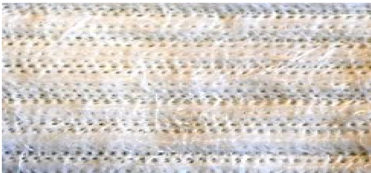
Εικόνα 74: Ένα πυρίμαχο θερμομονωτικό υλικό από ίνες ασβεστίου πυριτίου.
