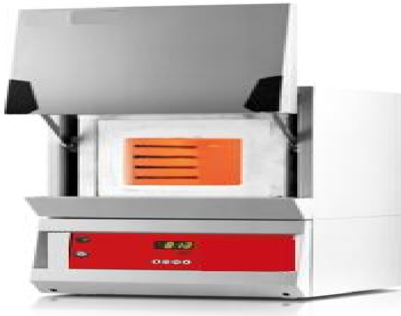
Εικόνα 62 : Φούρνος γρήγορης θέρμανσης θαλάμου.
