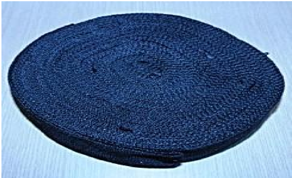
Εικόνα 72: Πυρίμαχο θερμομονωτικό υλικό με ίνες PAN (Polyacetylo Nitril).
