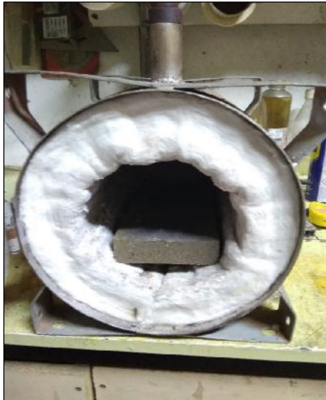
Εικόνα 96: Τοποθέτηση πυρότουβλου στο κάτω μέρος, στο σημείο που εισέρχεται η
