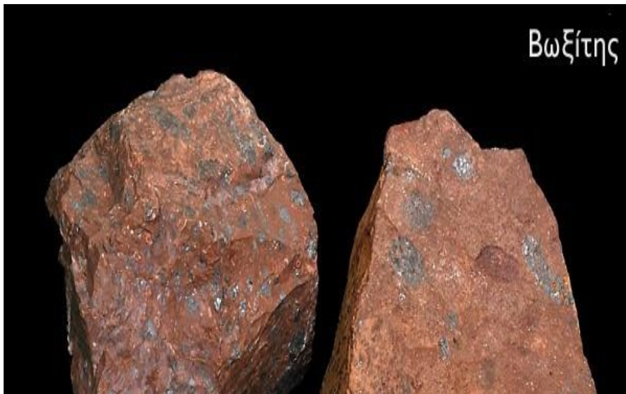
Εικόνα 25: Παρουσιάζεται ένα κομμάτι βωξίτη από όπου λαμβάνεται η αλουμίνα.
