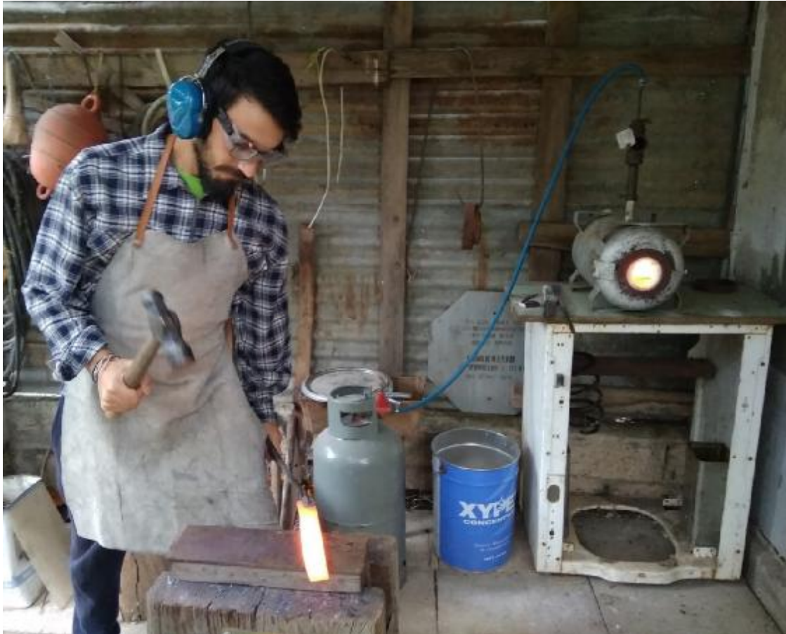
Εικόνα 100: Στην εικόνα φαίνεται το μέταλλο κατά την σφυρηλάτηση, που μόλις βγήκε από το αναμένο καμίνι στο βάθος, όπως και ο απαραίτητος εξοπλισμός ασφαλείας του χειριστή.
