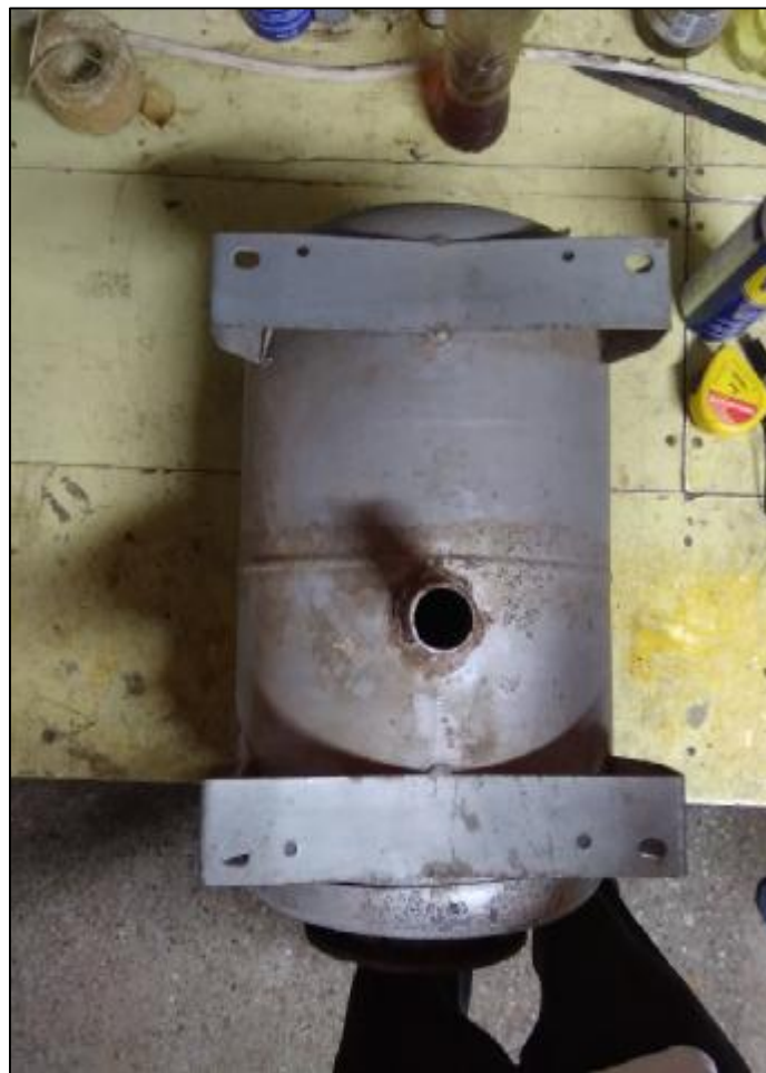
Εικόνα 92: Κάτοψη καμινιού, είναι εμφανής η οπή για την είσοδο της φλόγας.
