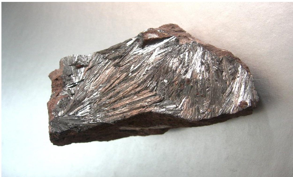
Εικόνα 22: Παρουσιάζεται ένα κομμάτι πυρολουσίτη, πολύ πλούσιο με εξαιρετικό ασημίορειχάλκινο χρώμα και κρυσταλλικό και στις δύο πλευρές από το οποίο λαμβάνεται το μαγγάνιο.
