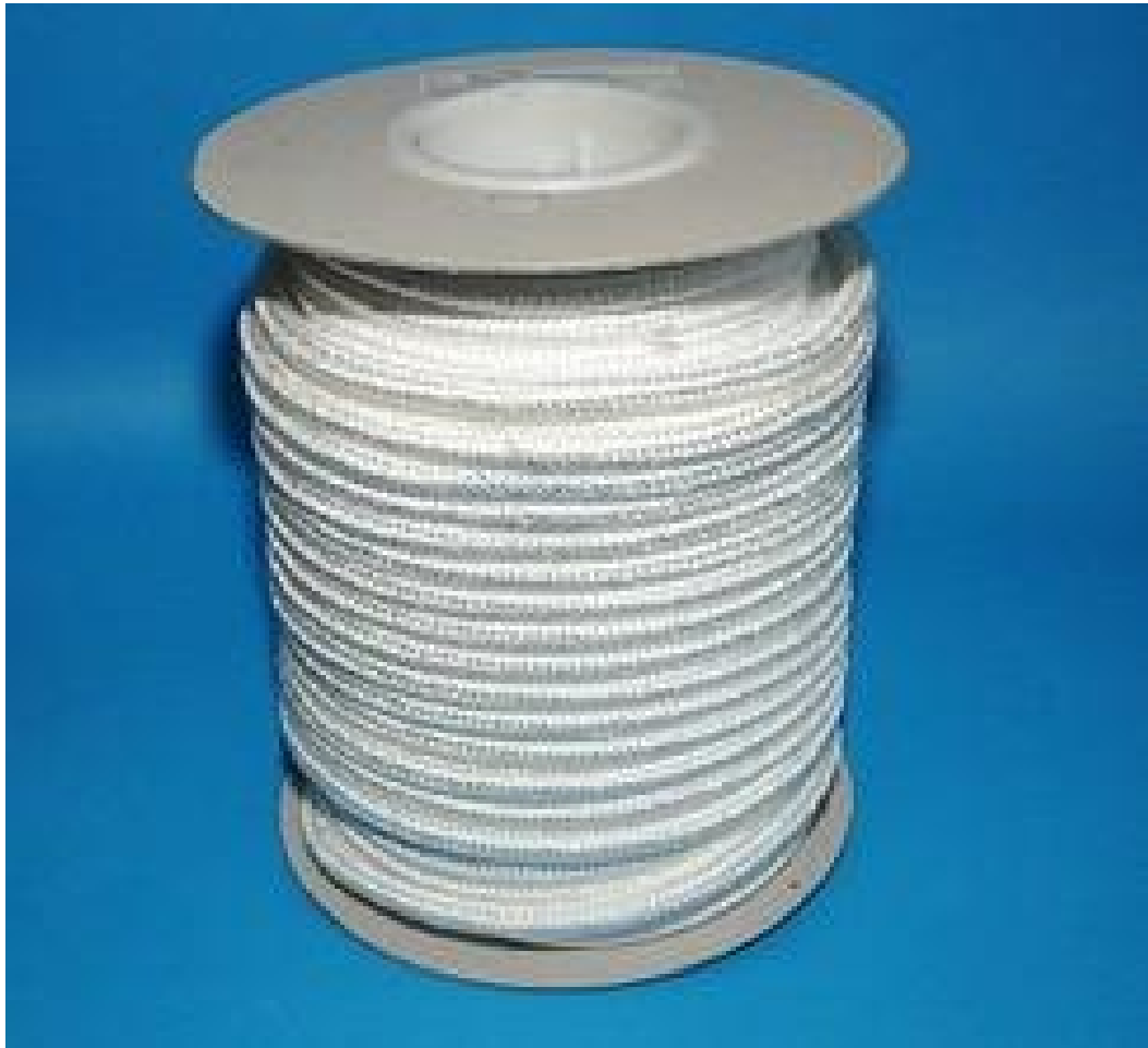
Εικόνα 75 : Στην εικόνα φαίνεται ένα πυρίμαχο θερμομονωτικό υλικό πυριτικής βάσης ( \text{SiO}_2 ).
