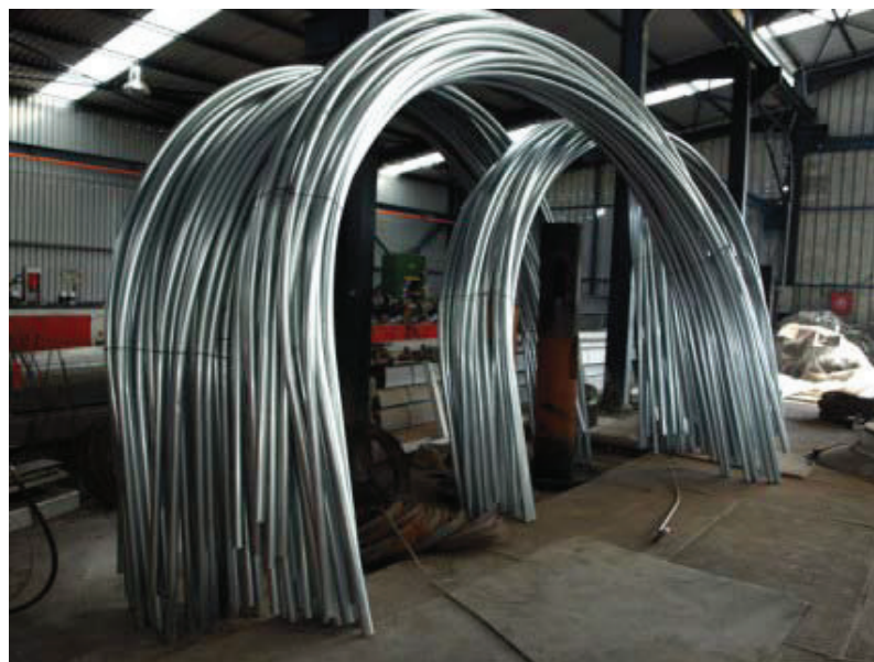
Εικόνα 7. Μεταλλικά τόξα θερμοκηπίου.
