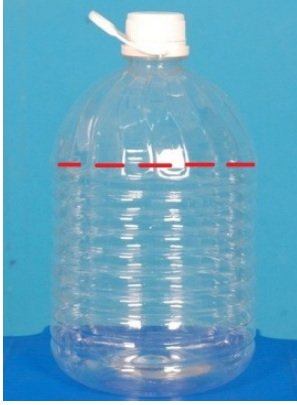
Εικόνα 17 Κατασκευή επωαστήρα 3 λίτρων από πλαστικό πολυκαρβονικό δοχείο μεταλλικού νερού
