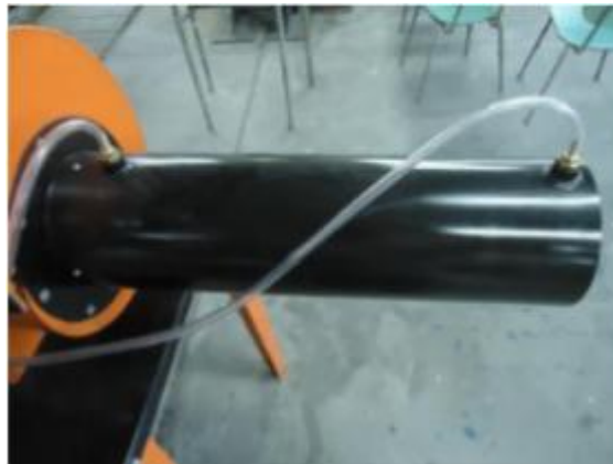
Εικόνα 19: Σωλήνας για την μέτρηση του μανομετρικού για τον αγωγό αναρρόφησης [9].
