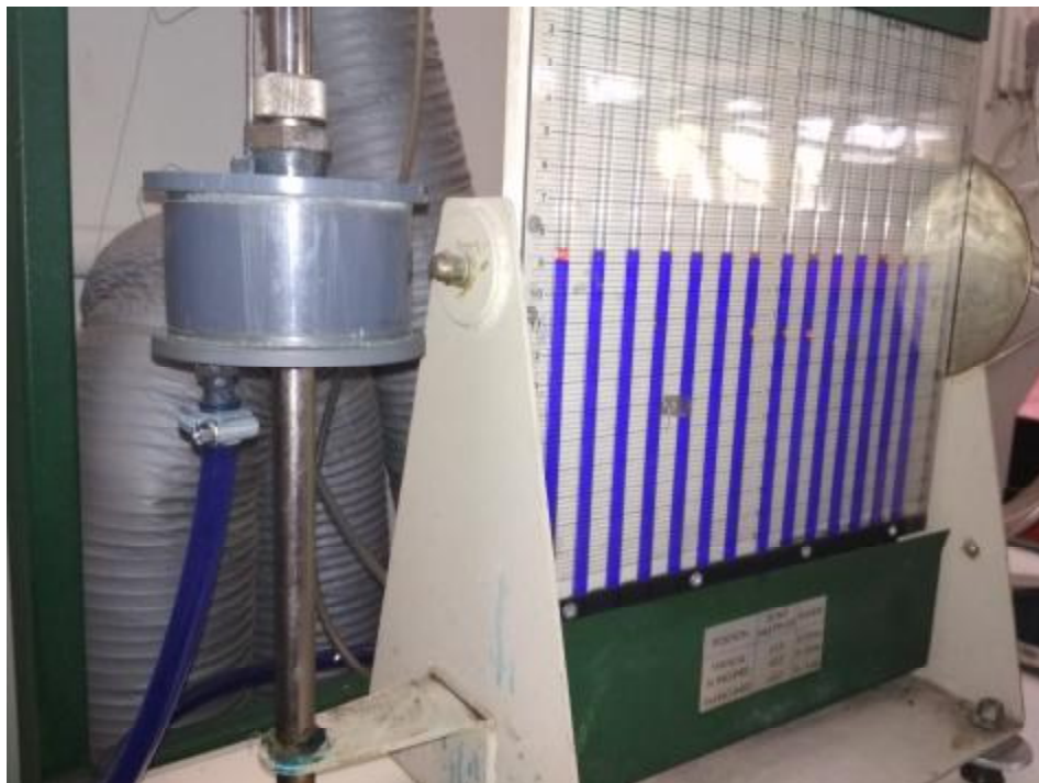
Εικόνα 10 Η δεξαμενή ρύθμισης το ύψους των στηλών.
