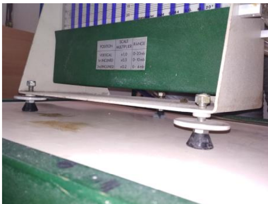
Εικόνα 11 Τα «πόδια», κοχλίες οριζοντίωσης του μανομέτρου.
