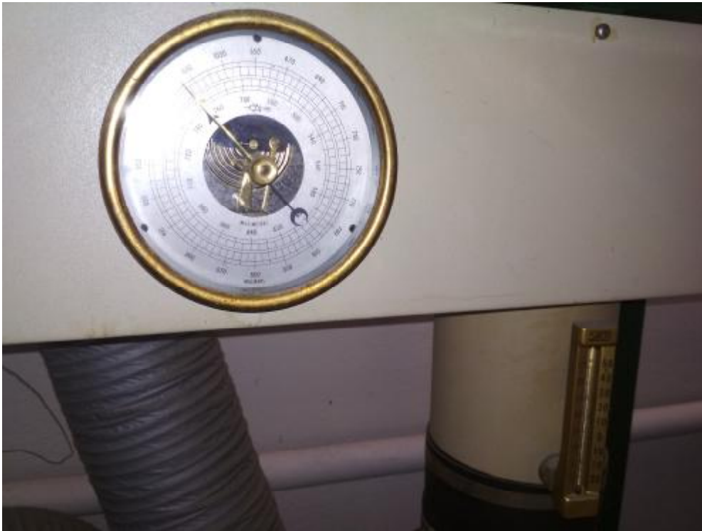
Εικόνα 17 Τα όργανα μέτρησης θερμοκρασίας και πίεσης της συσκευής.
