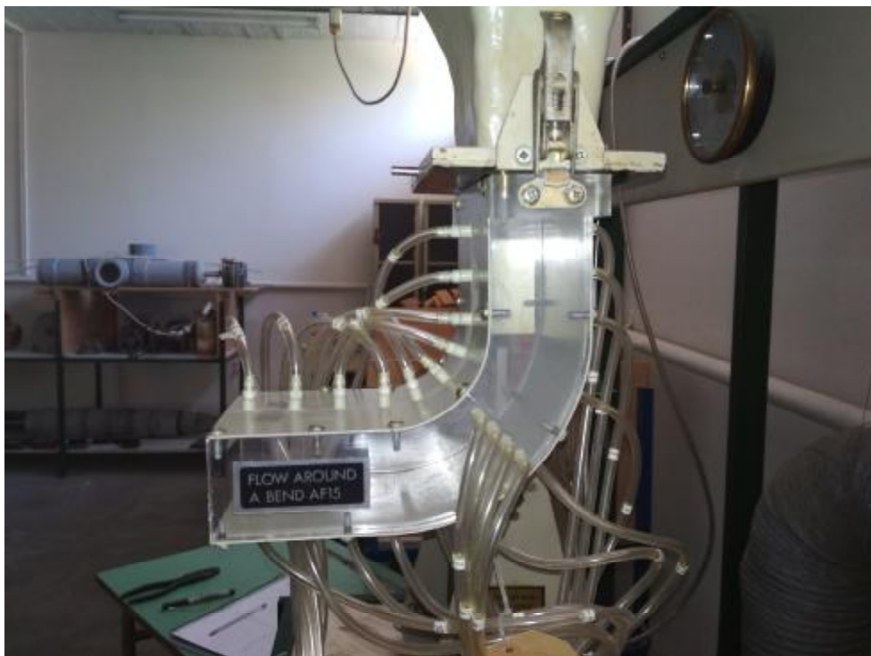
Εικόνα 14 Πλάγια άποψη του εξαρτήματος ροής 90 μοιρών..
