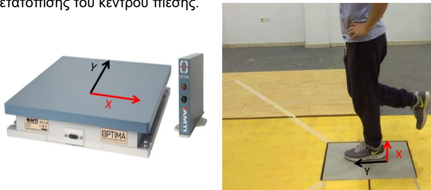
Εικόνα 7.1 Οι άξονες Y και X στο δυναμοδάπεδο.
