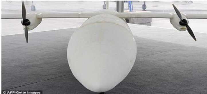
Εικόνα 2-2 : Thor, το πρώτο αεροπλάνο που εκτυπώθηκε πλήρως.
