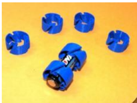
Εικόνα 2-11: Αντάπτορας μπαταρίας κατασκευασμένος μέσω 3D εκτύπωσης
