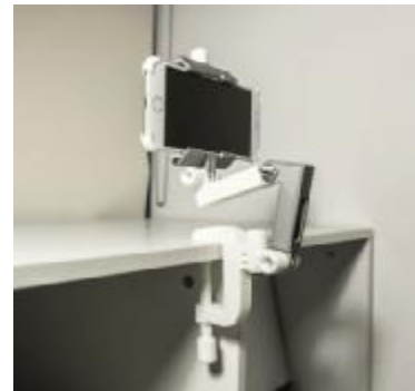
Εικόνα 2-20: Τρισδιάστατο εκτυπωμένο σύστημα στήριξης για μικρές συσκευές
