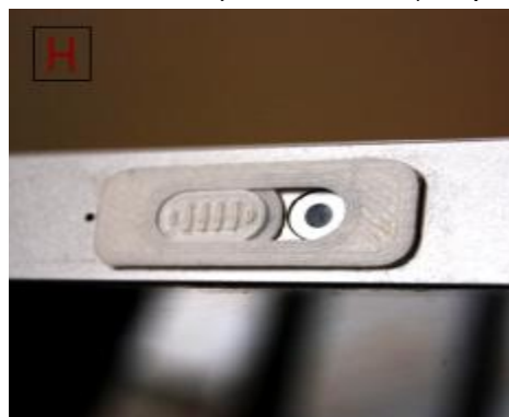
Εικόνα 2-14: Κάλυμμα κάμερας φορητού υπολογιστή κατασκευασμένο μέσω 3D εκτύπωσης
