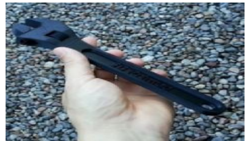
Εικόνα 2-10: Αρθρωτό πλαστικό κλειδί από τρισδιάστατη εκτύπωση
