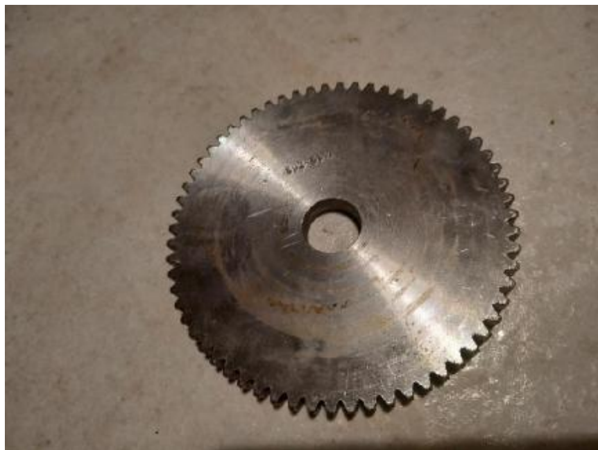
Εικόνα 4.18: 7 ος οδοντωτός τροχός m1.5 z63
