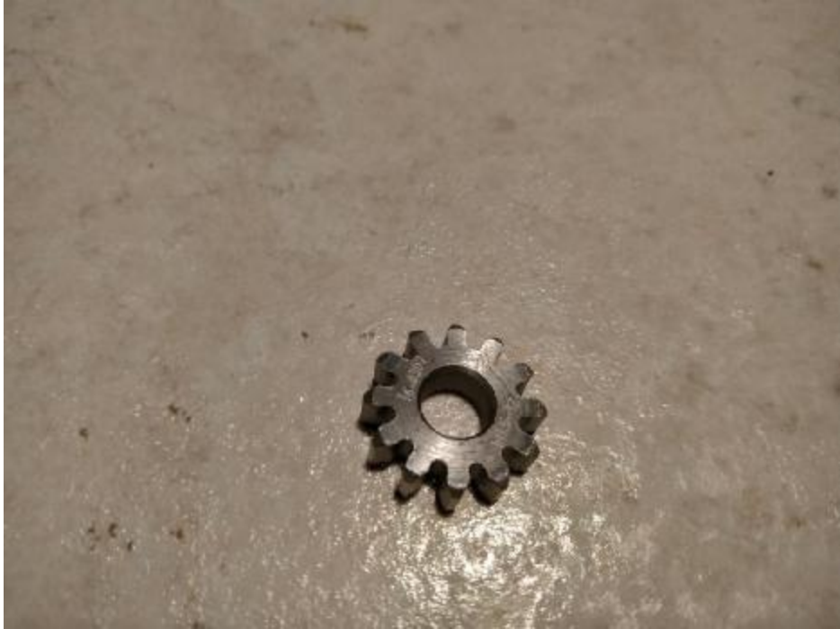
Εικόνα 4.21: 10 ος οδοντωτός τροχός m1.5 z12
