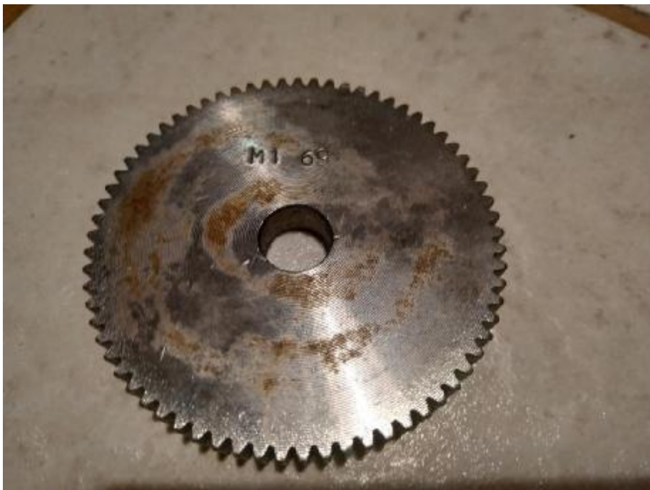
Εικόνα 4.22: 11 ος οδοντωτός τροχός m1.0 z69
