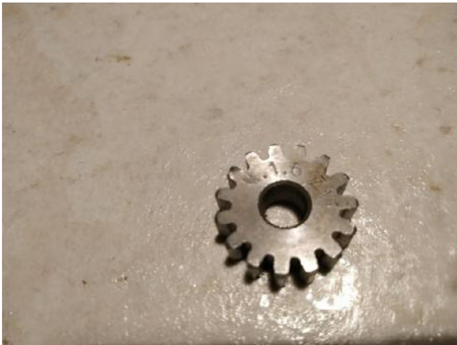
Εικόνα 4.16: 5 ος οδοντωτός τροχός m1.5 z15
