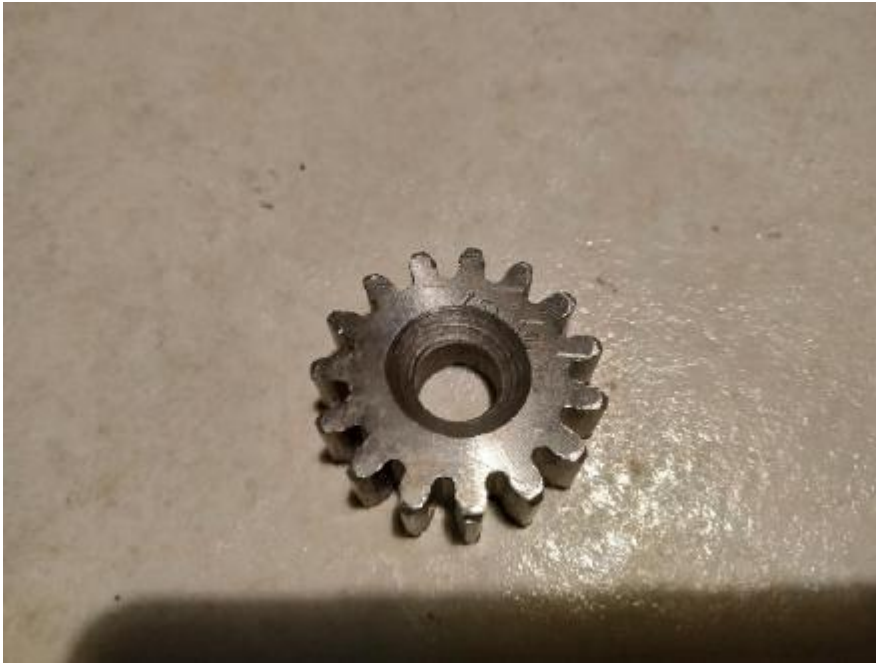
Εικόνα 4.19: 8 ος οδοντωτός τροχός m2.0 z15
