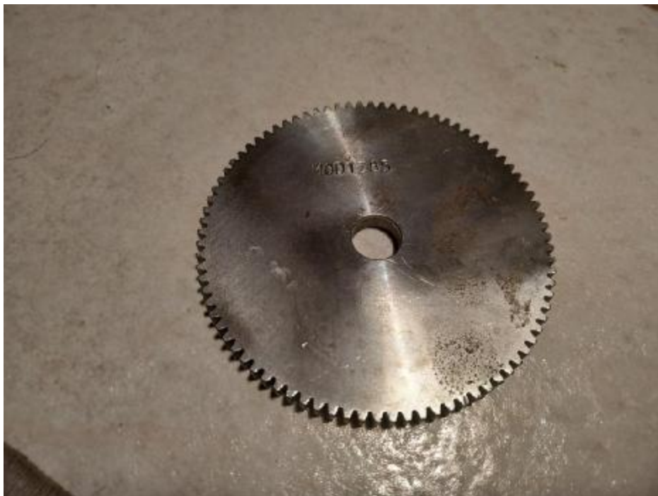
Εικόνα 4.20: 9 ος οδοντωτός τροχός m1.0 z85
