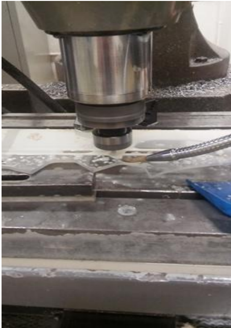
Εικόνα 5.1: Κατασκευή καλουπιού από plex-glass για το μπροστινό μέρος του ωρολογίου.
