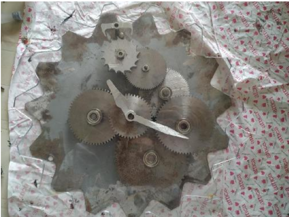
Εικόνα 5.13: Ολοκλήρωση και συναρμολόγηση εσωτερικού μηχανισμού.
