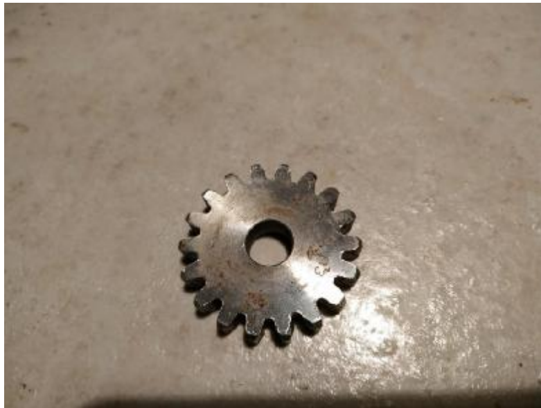
Εικόνα 4.14: 3 ος οδοντωτός τροχός m2,0 z18
