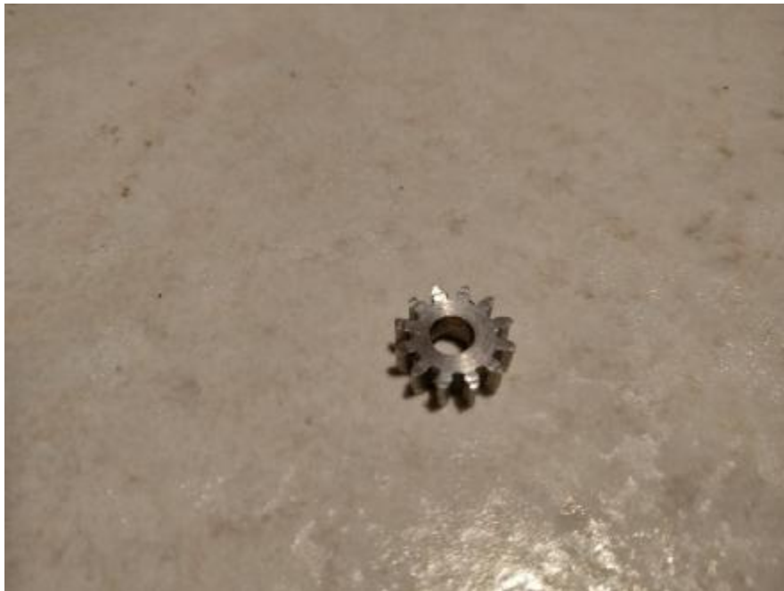
Εικόνα 4.24: 13 ος οδοντωτός τροχός m1.0 z12
