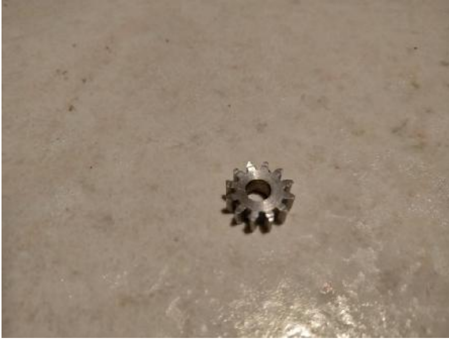
Εικόνα 4.23: 12 ος οδοντωτός τροχός m1.0 z12
