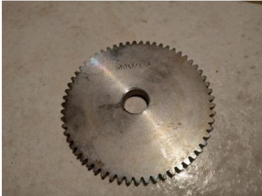
Εικόνα 4.15: 4 ος οδοντωτός τροχός m1,5 z60
