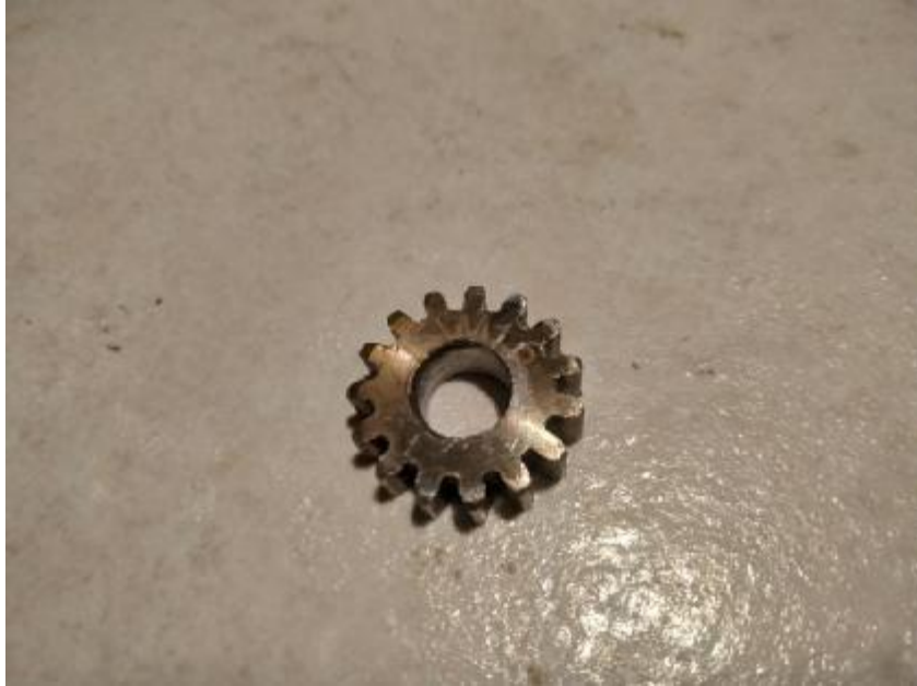
Εικόνα 4.13: 2 ος οδοντωτός τροχός m1,5 z15
