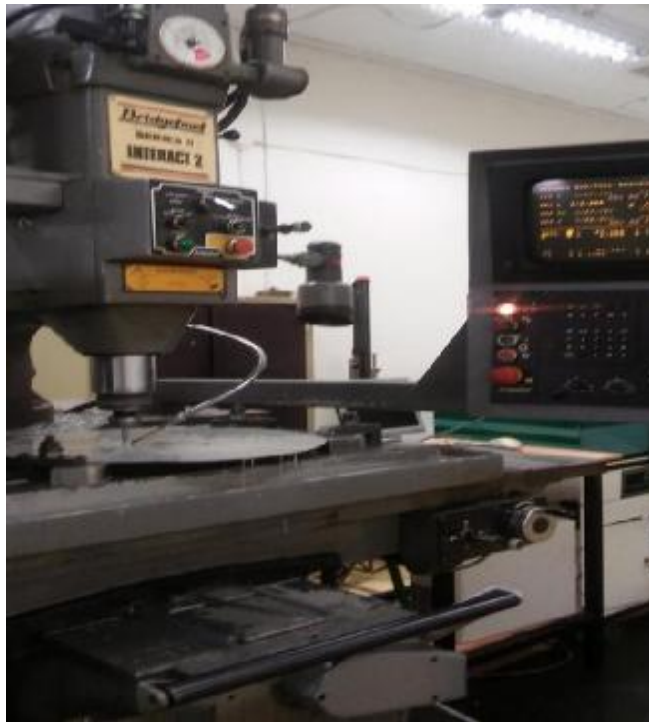
Εικόνα 5.6: Κατασκευή καλουπιού σε CNC Φρέζα.
