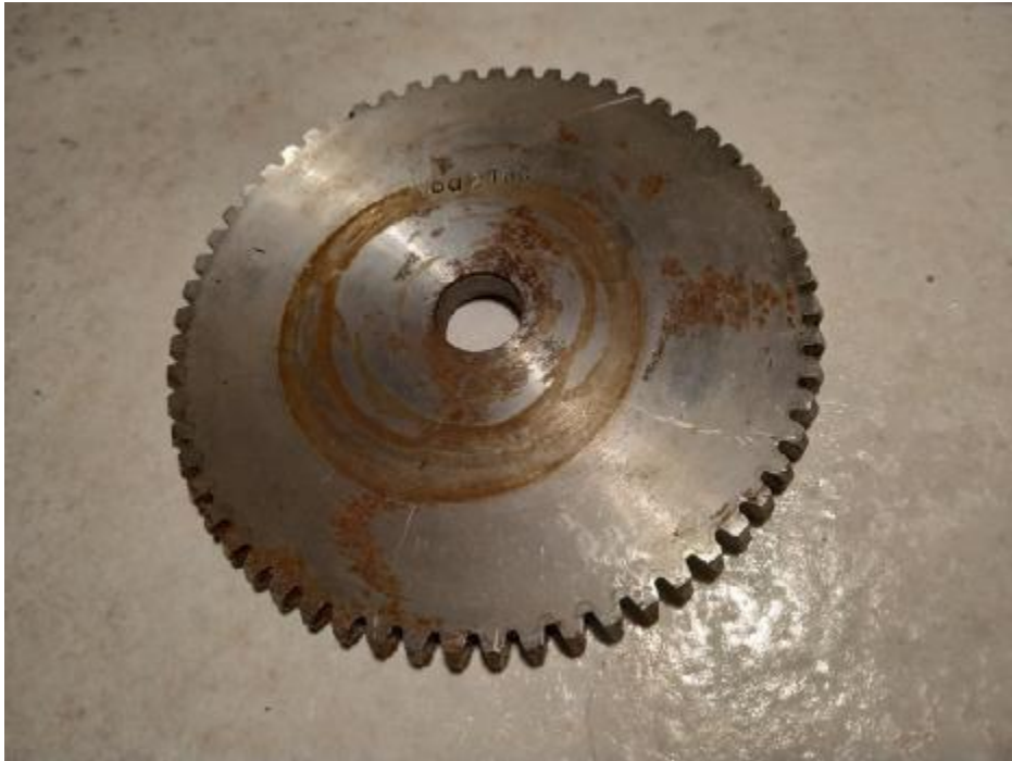
Εικόνα 4.17: 6 ος οδοντωτός τροχός m2.0 z60
