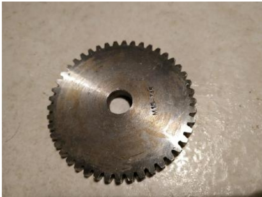
Εικόνα 4.12: 1 ος οδοντωτός τροχός m1,5 z45
