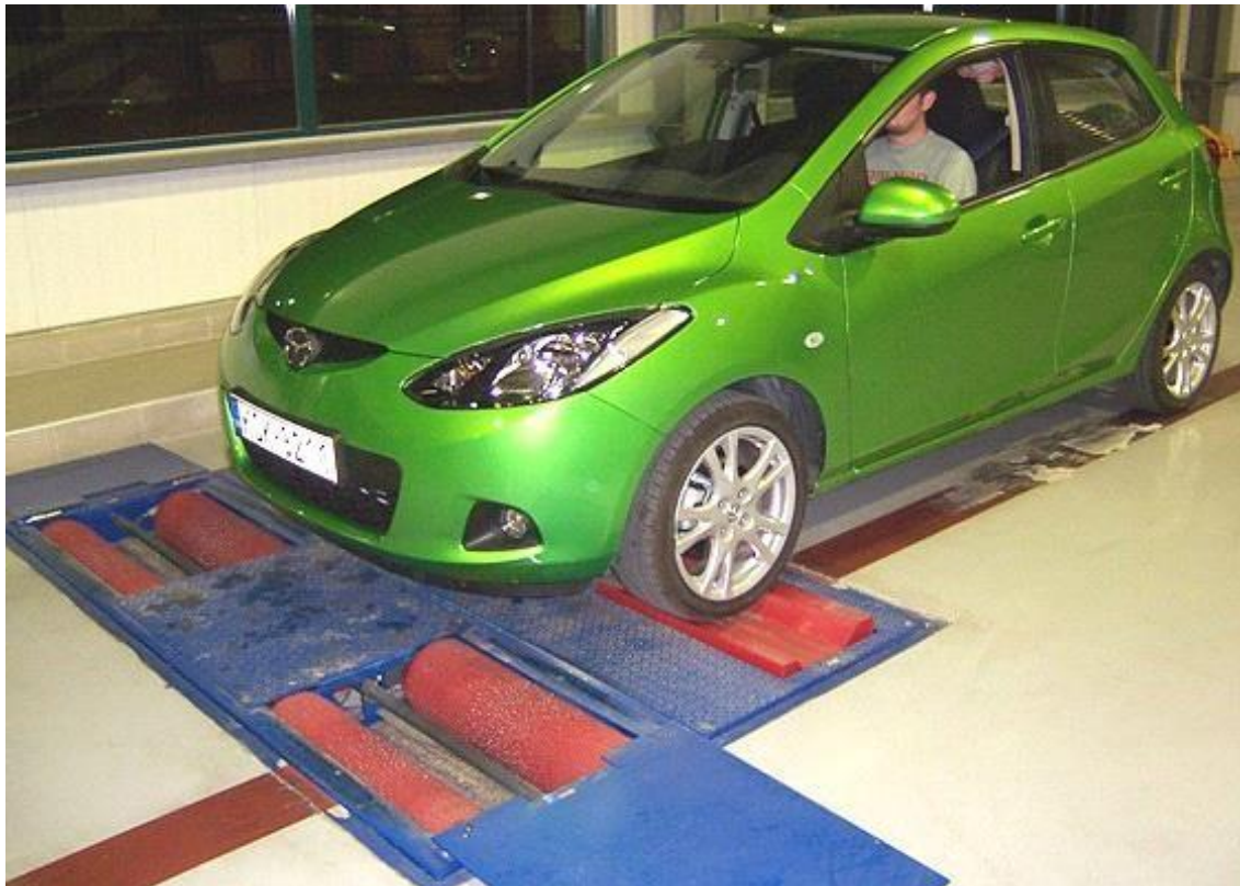
Εικόνα 3.4 Έλεγχος με το αμορτισερόμετρο.
