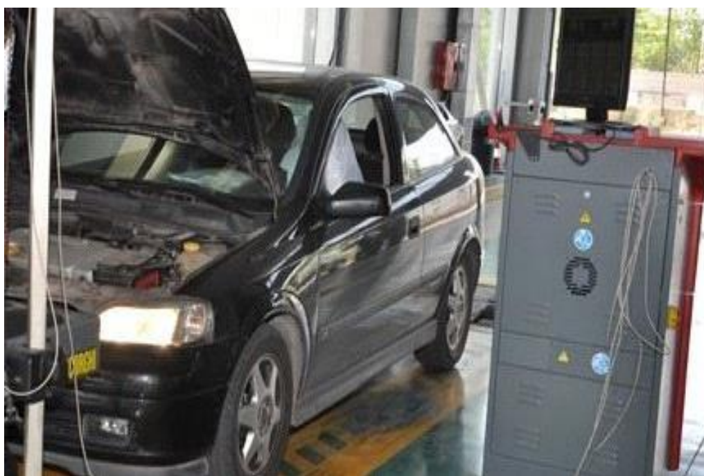
Εικόνα 3.5 Έλεγχος με το φωτόμετρο.
