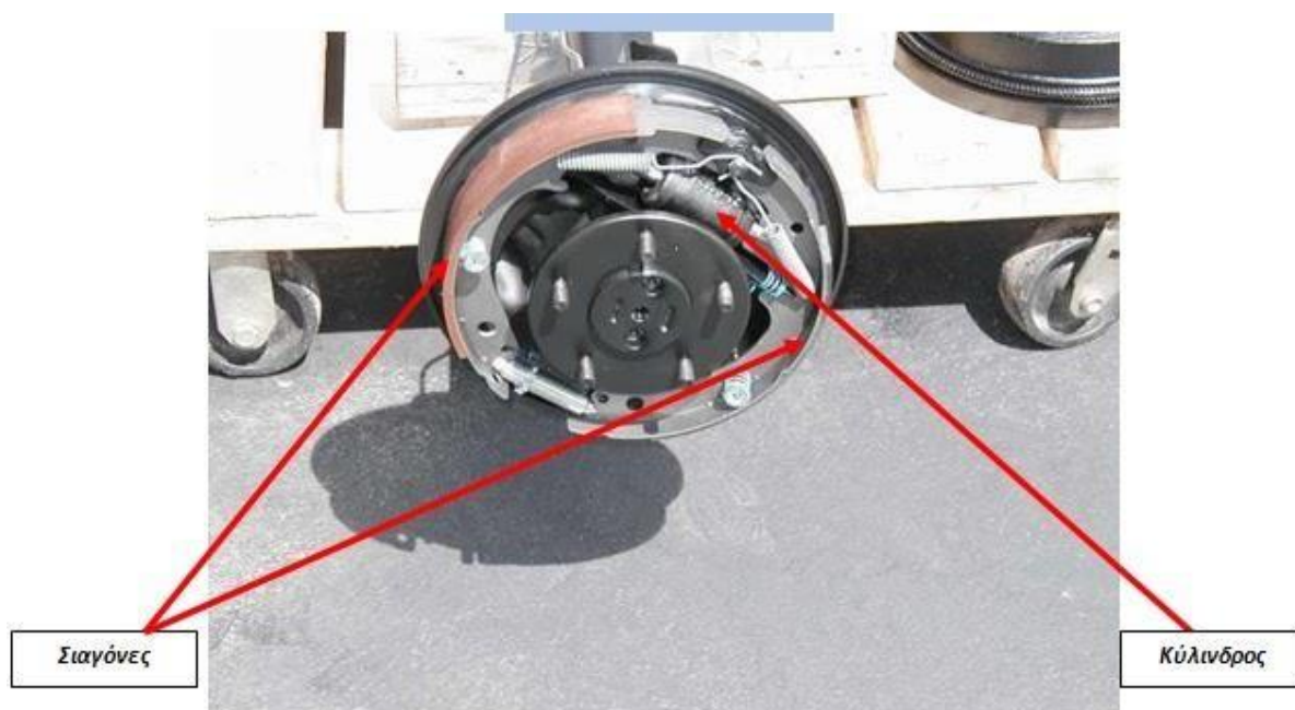
Εικόνα 4.2 Υδραυλικά φρένα τεχνολογίας ταμπούρου
