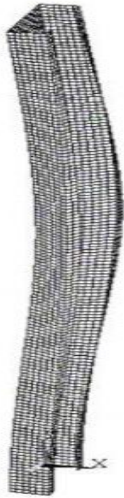
Εικόνα 2: Καθολικός λυγισμός, Βιβλιογραφία(4)
