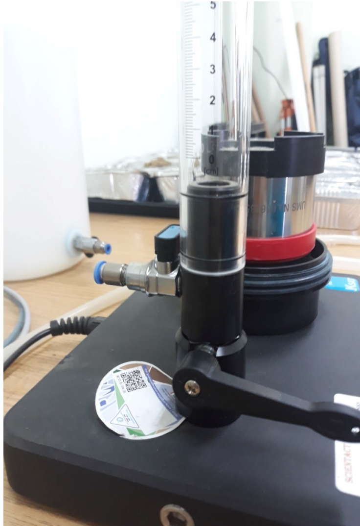
Εικόνα 3 Μοχλός επιλογής της μεθόδου (σταθερό ή μεταβλητό φορτίο)
