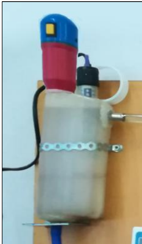
Εικόνα 20: Ταμιευτήρας με τον αναδευτήρα και το θερμοστάτη-αντίσταση
