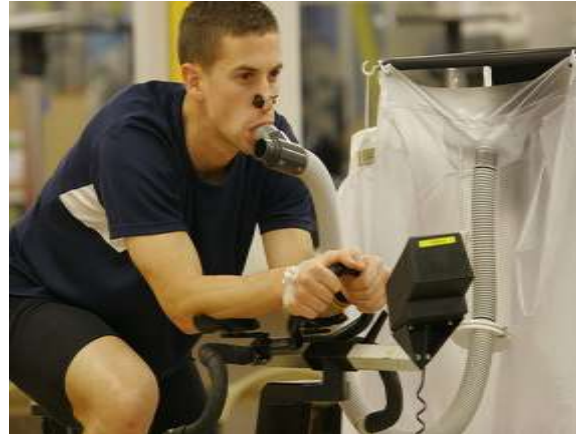
Εικόνα 3: Έμμεση θερμιδομετρία ανοιχτού κυκλώματος ( https://slideplayer.gr/slide/11142697/ )
