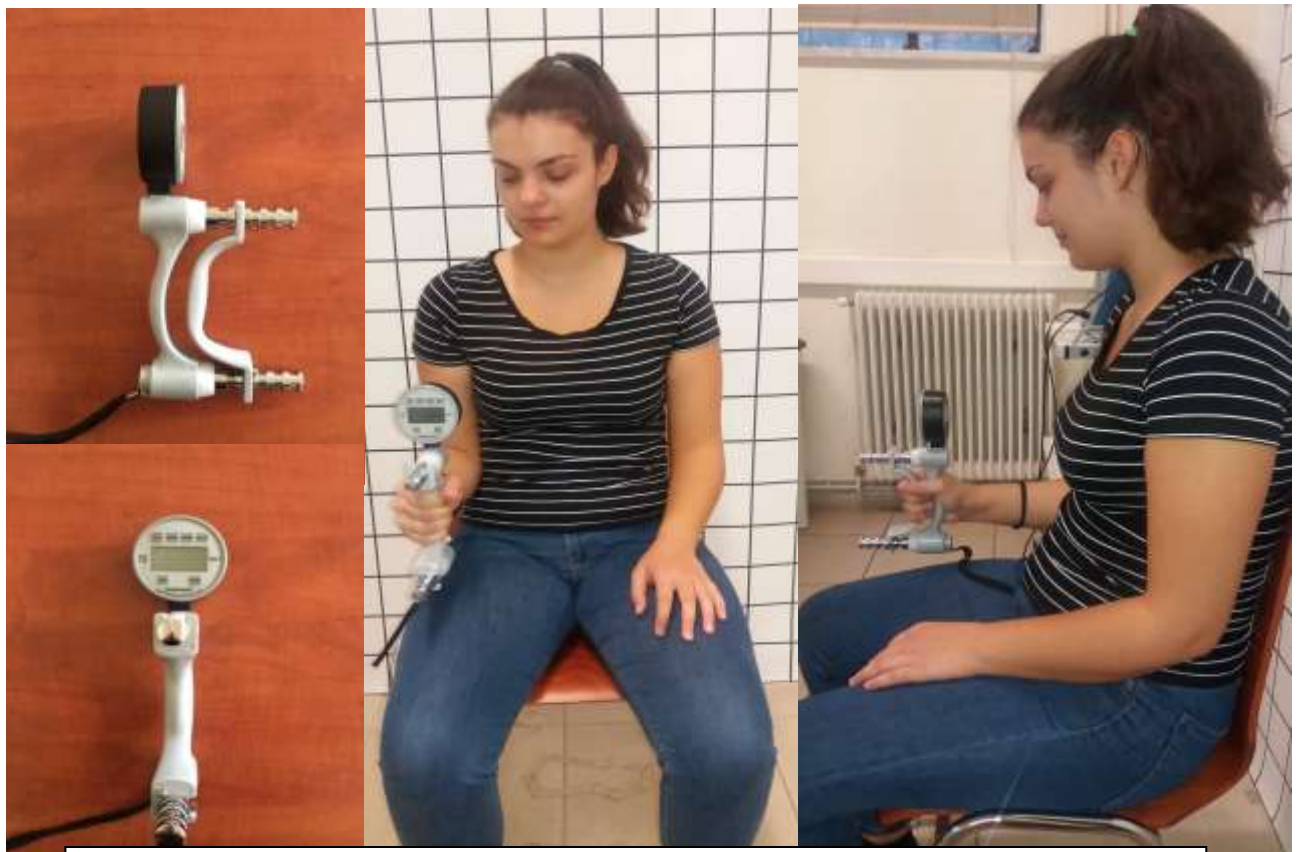
Εικόνα 10: Τρόπος μέτρησης δύναμης λαβής (α)Δυναμόμετρο «Saehan», (β) Στάση σώματος
