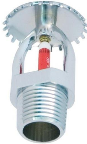
Εικόνα 10: Sprinkler 1/2" 68οC, τοποθέτηση προς τα πάνω
