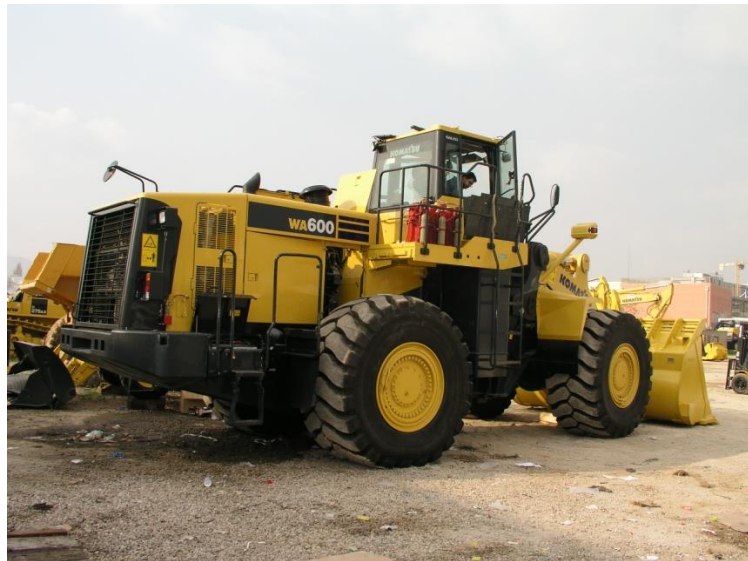
Εικόνα 29: Εξωτερική όψη μηχανήματος με το σύστημα πυρόσβεσης
