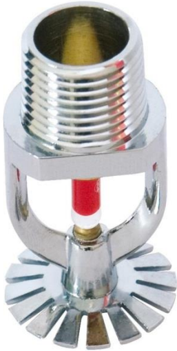
Εικόνα 9: Sprinkler 1/2" 68οC, τοποθέτηση προς τα κάτω
