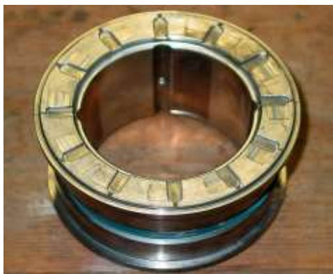
Εικόνα 6.14 : Αριστερά αξονικό έδρανο με αυλάκια, δεξιά ακτινικά και αξονικά έδρανα.
