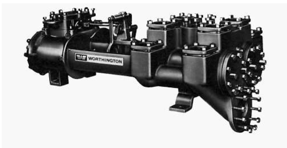
Εικόνα 4.23: Εξωτερική μορφή ιππαρίου. (πηγή: Motor Oil Hellas, εκπαιδευτικά εγχειρίδια)
