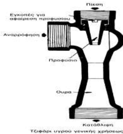
Εικόνα 4.40 : Τομή τζιφαριού. (πηγή: Motor Oil Hellas, εκπαιδευτικά εγχειρίδια)
