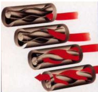
Εικόνα 4.26 : Αριστερά αρχή λειτουργίας κοχλία και δεξιά τομή αντλίας. (πηγή: Motor Oil Hellas, εκπαιδευτικά εγχειρίδια)
