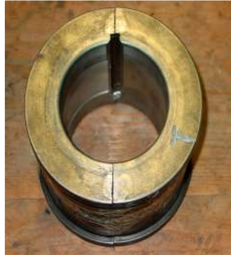
Εικόνα 6.12 : Αριστερά έχουμε ενιαία απλά ακτινικά έδρανα και δεξιά διαιρούμενο ακτινικό έδρανο με αυλάκια. (πηγή: Motor Oil Hellas, εκπαιδευτικά εγχειρίδια)
