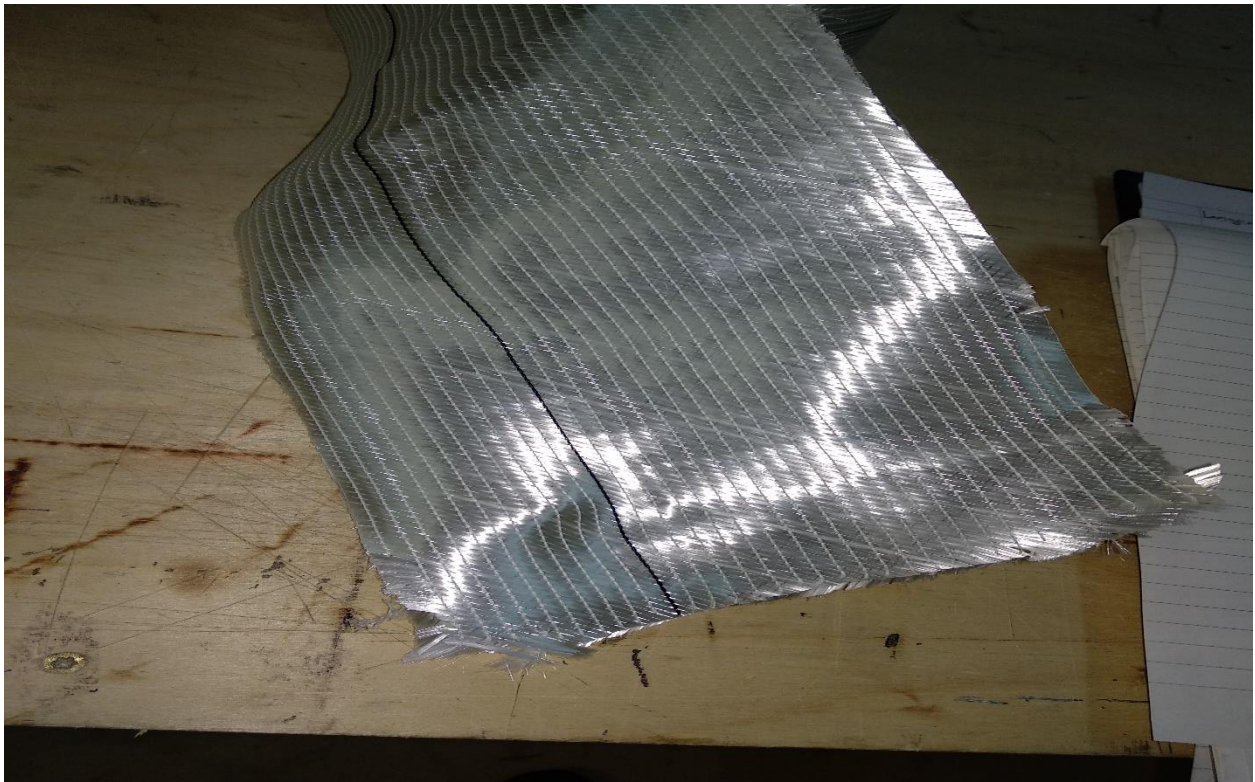
Εικόνα 35: Υαλο- ύφασμα πυκνότητας 450 γραμμαρίων ανά τετραγωνικό μέτρο.
