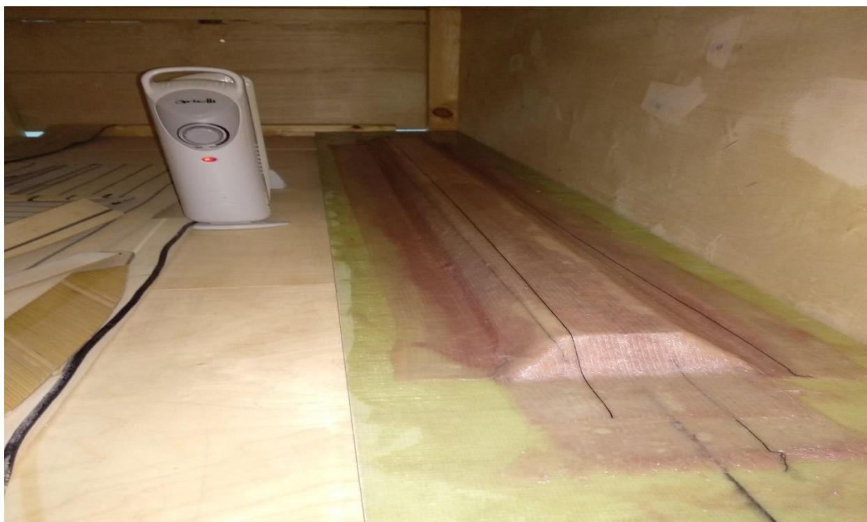
Εικόνα 39: Τοποθέτηση της πασαρέλας σε αυτοσχέδιο φούρνο στους 60 βαθμούς κελσίου για την φάση σκλήρυνσης.
