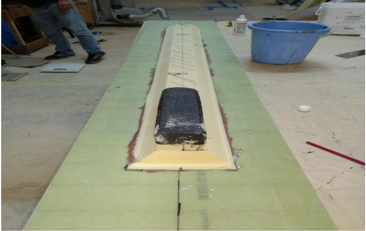
Εικόνα 34: Τοποθέτηση του νεύρου με την βοήθεια βάρους για την καλύτερη κόλληση.
