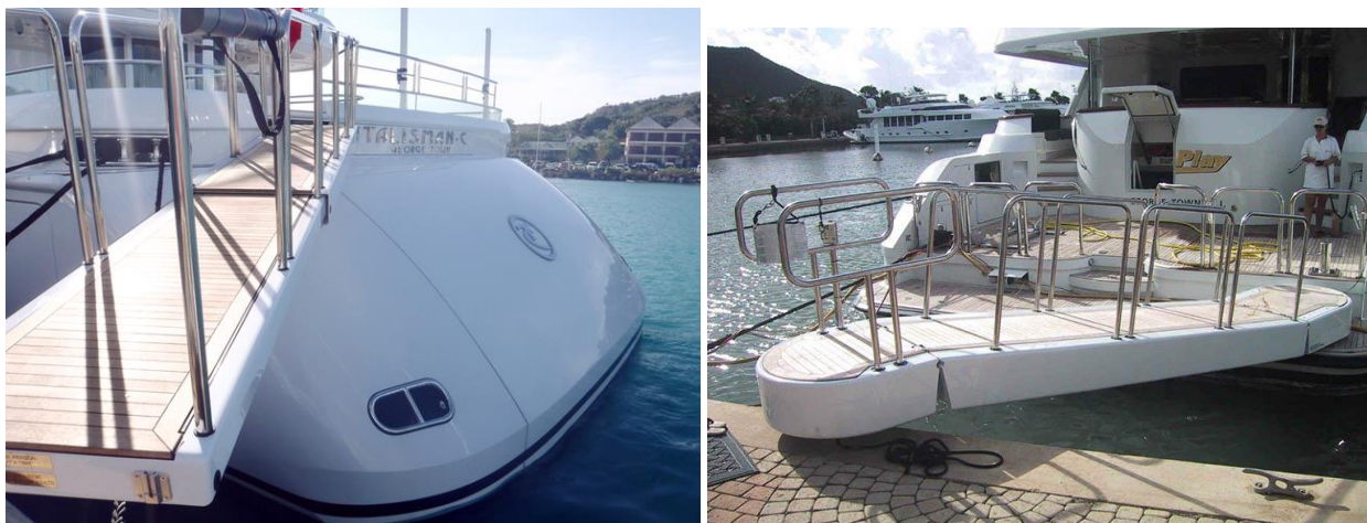
Εικόνα 10 Πασαρέλα τύπου Ελβετικού σουγιά ( www.nautical-structures.com , www.yachting-pages.com )
