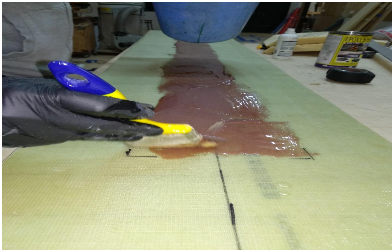
Εικόνα 33: Άπλωμα εποξικής ρητίνης για τοποθέτηση του νεύρου.
