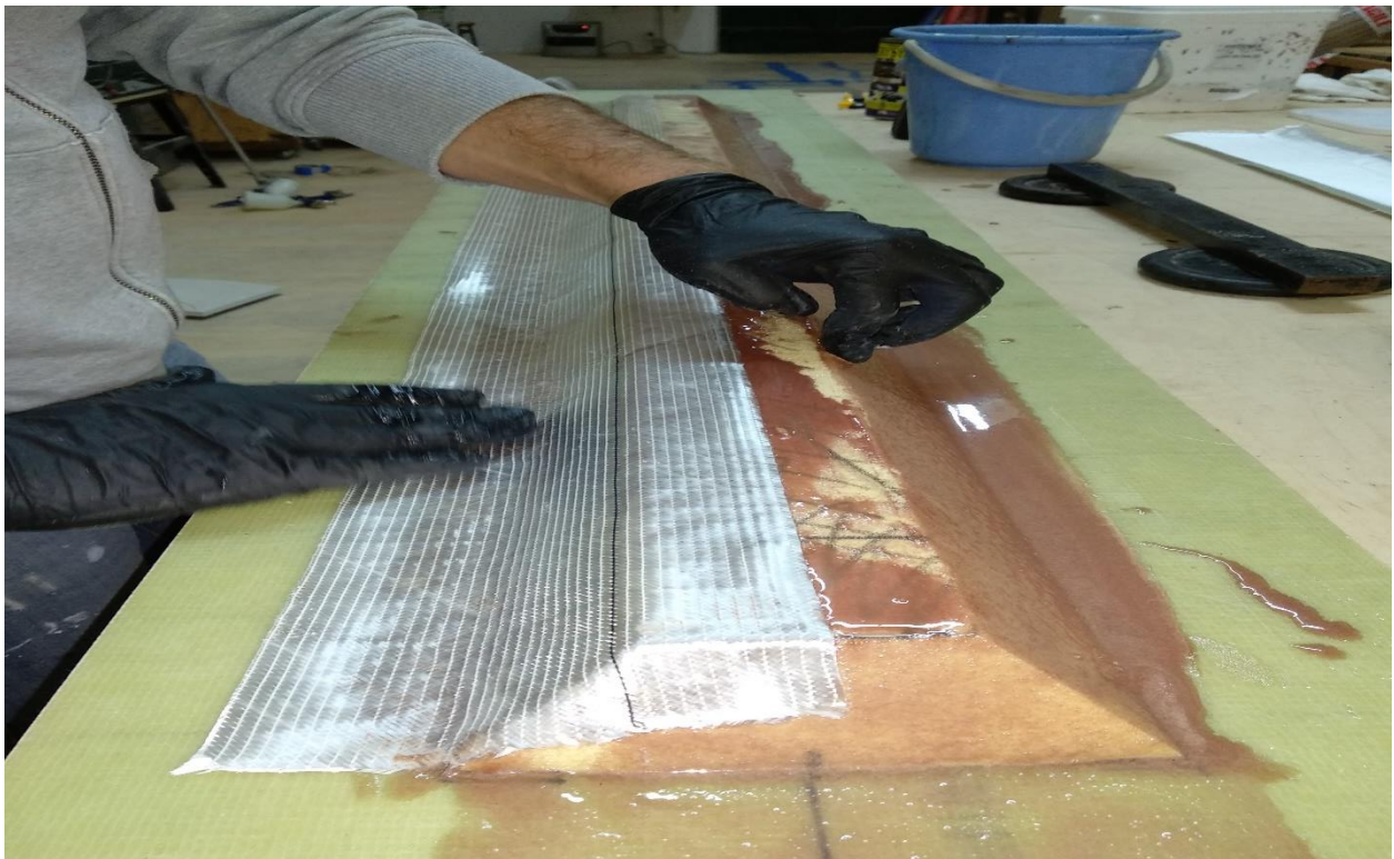
Εικόνα 37: Τοποθέτηση του υαλο-υφάσματος.
