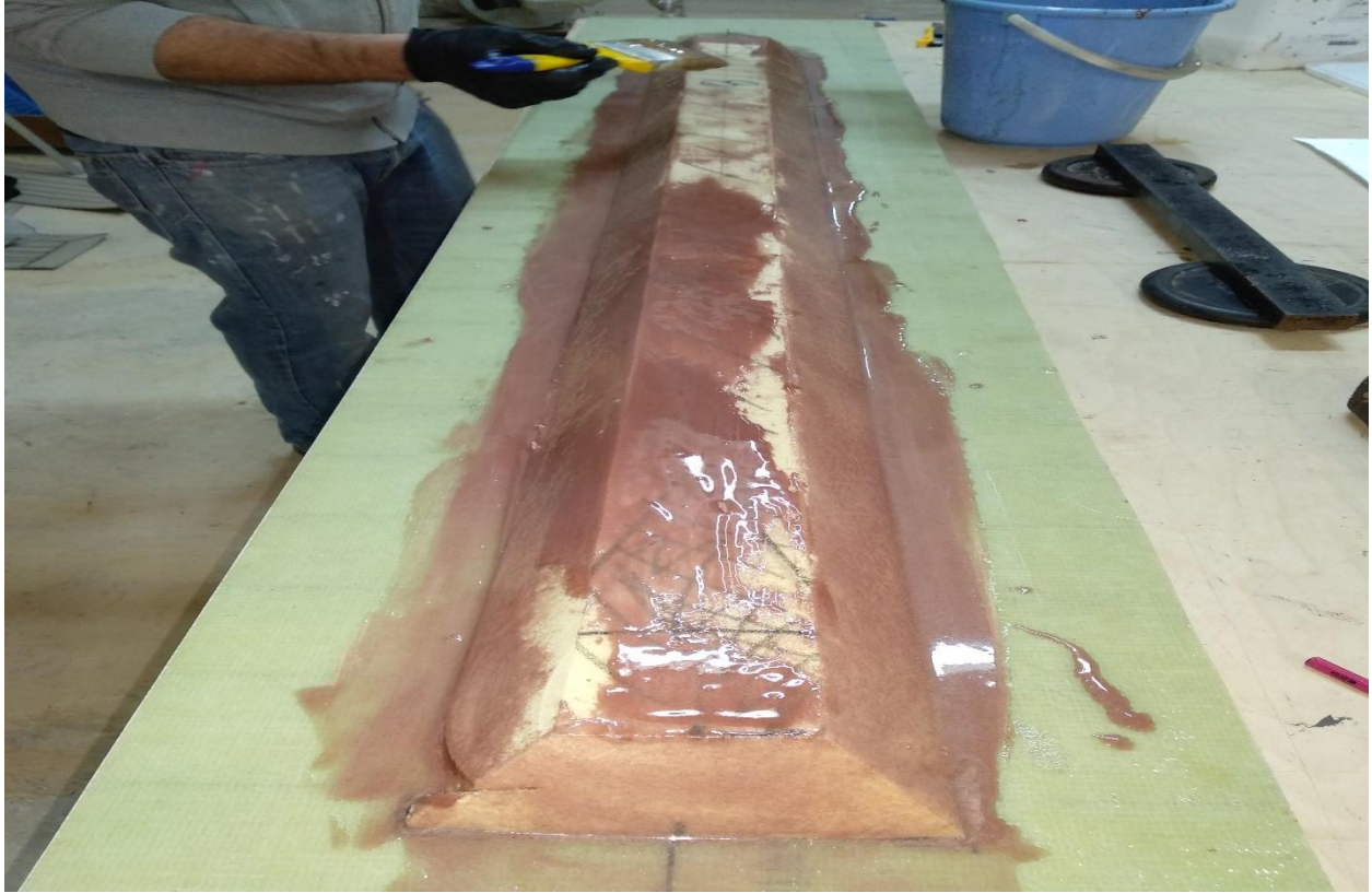
Εικόνα 36: Επάλειψη του νεύρου με εποξική ρητίνη πριν την τοποθέτηση του υαλο-υφάσματος.
