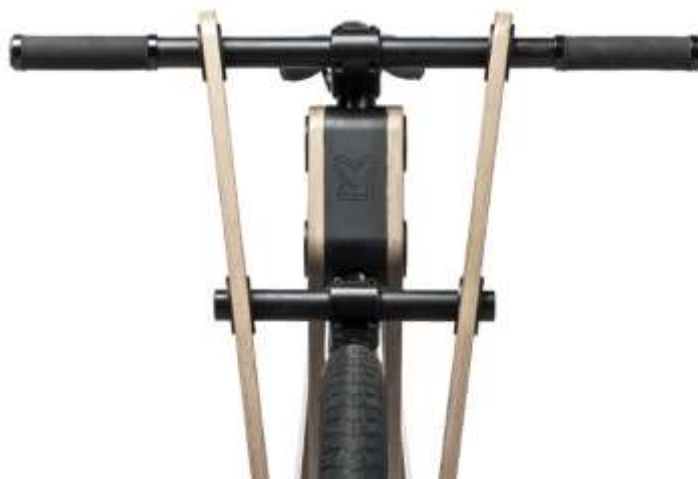
Εικόνα 40: Σύστημα διεύθυνσης ξύλινου ποδήλατου τύπου sandwich [Πηγή: https://www.designisthis.com/blog/post/xilino-podilato-sandwichbike-basten-leijh ]
