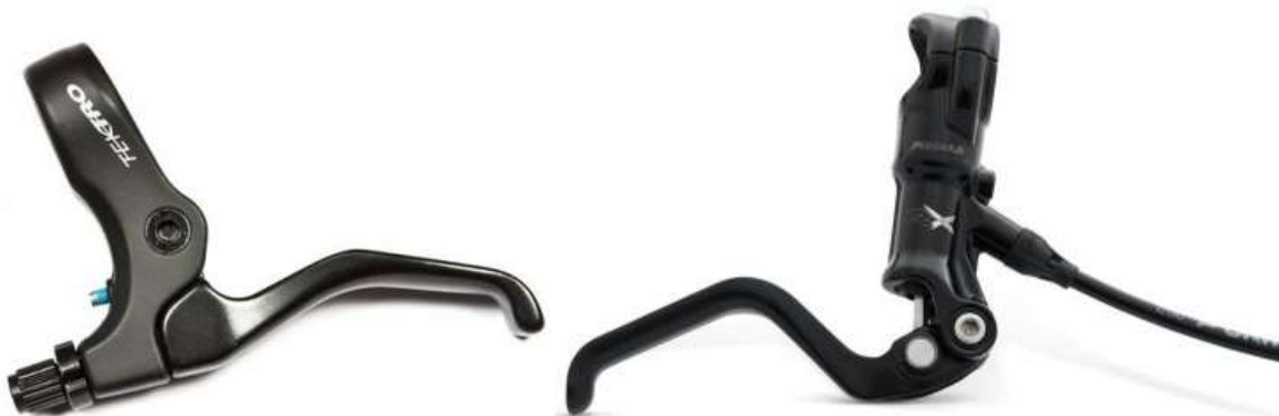
Εικόνα 26: Μανέτα με τη χρήση ντιζών (αριστερά) & με τη χρήση υδραυλικών (δεξιά) [Πηγή: https://www.gatsoulis.gr/ ]
