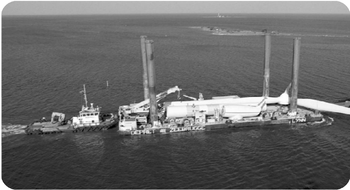
Εικόνα 2.23: Μεταφορά τμημάτων υπεράκτιας Α/Γ.
