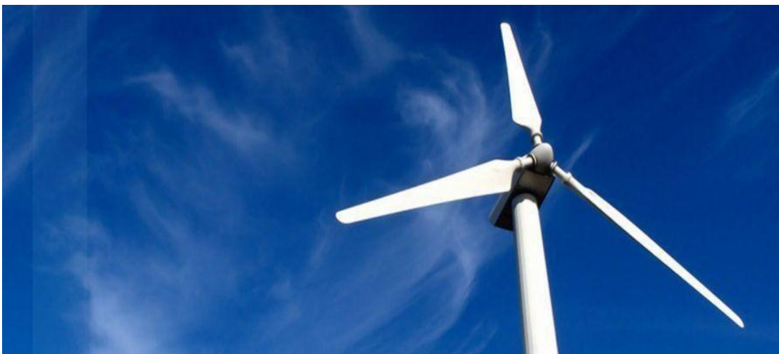
Εικόνα 2.5: Ανεμογεννήτρια Οριζοντίου Άξονα.
