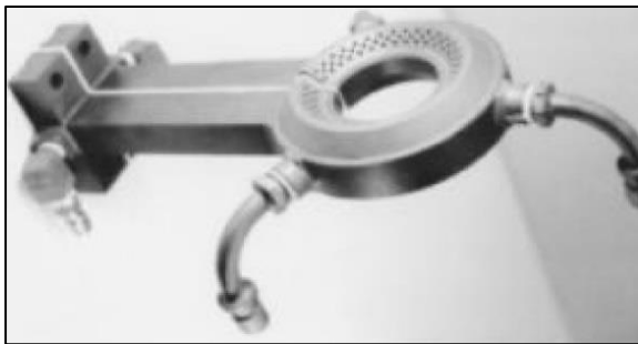
Εικόνα 3.6 Μιας σπείρας πηνίο συνεχούς θέρμανσης
