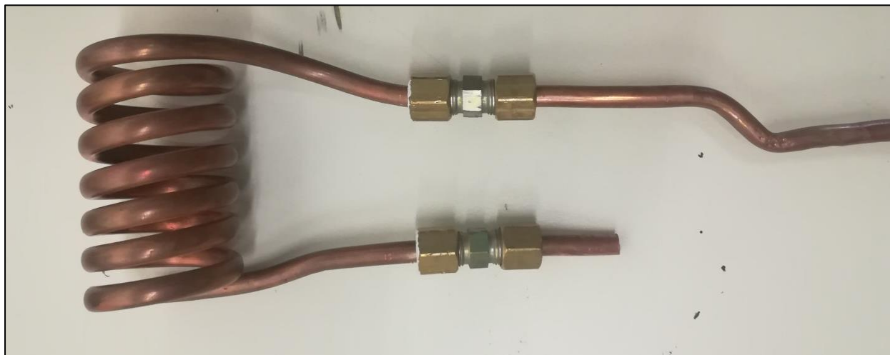
Εικόνα 6.13 Πηνίο 7 σπειρών με συνδέσμους ρακόρ.
