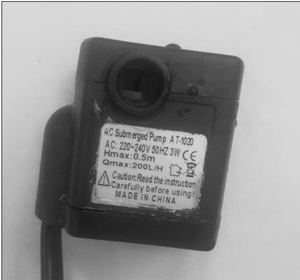
Εικόνα 6.9 Αντλία νερού μικρής ισχύος
