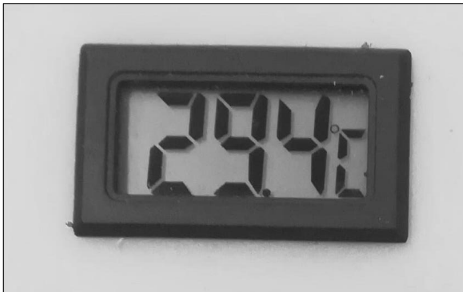
Εικόνα 6.11 Ψηφιακό θερμόμετρο τοποθετημένο στο πάνελ ελέγχου
