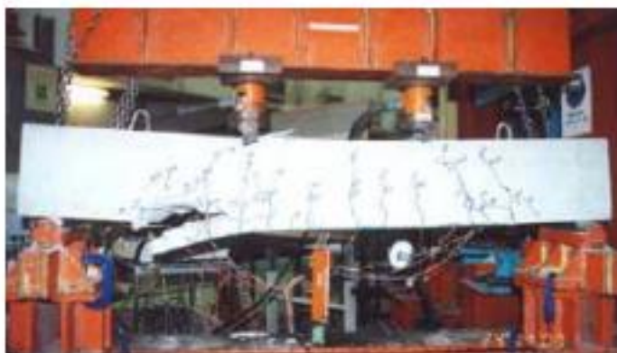
Σχ. 3.7 Διατμητική αστοχία στη θέση τερματισμού των εξωτερικών οπλισμών.
