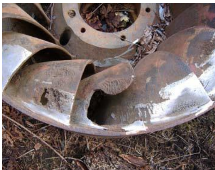
Σχήμα 4.19 Διάβρωση σπηλαιώσης σε στρόβιλο.
