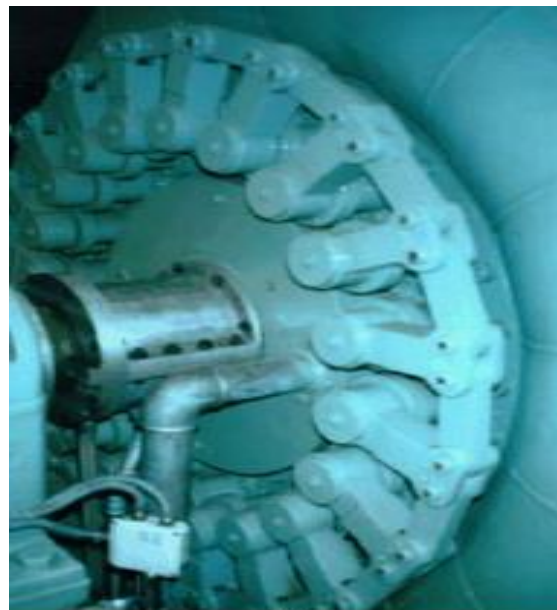
Σχήμα 4.12 (α) Αρχή λειτουργίας οδηγητικών περυγίων, (β) Οδηγητικά περύγια υδροστροβίλου Francis.
