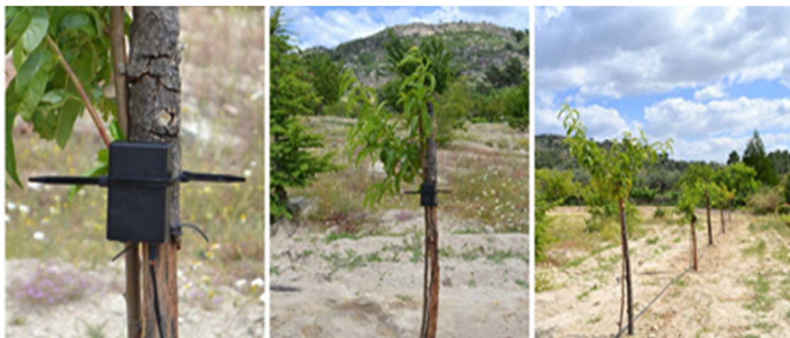
ED (End Device) συσκευή με προσαρμοσμένο αισθητήρα υγρασίας εδάφους
