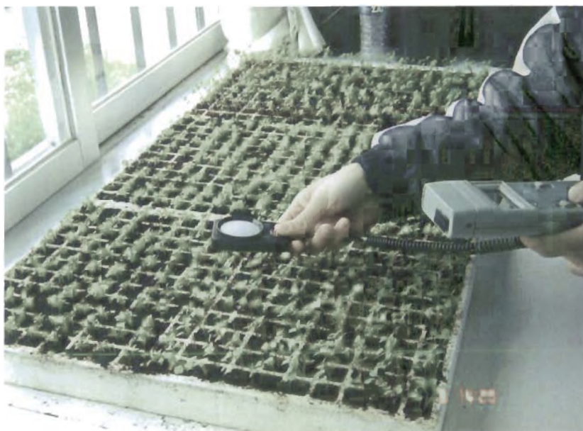
Εικόνα 6.2. Μέτρηση της έντασης φωτισμού.
