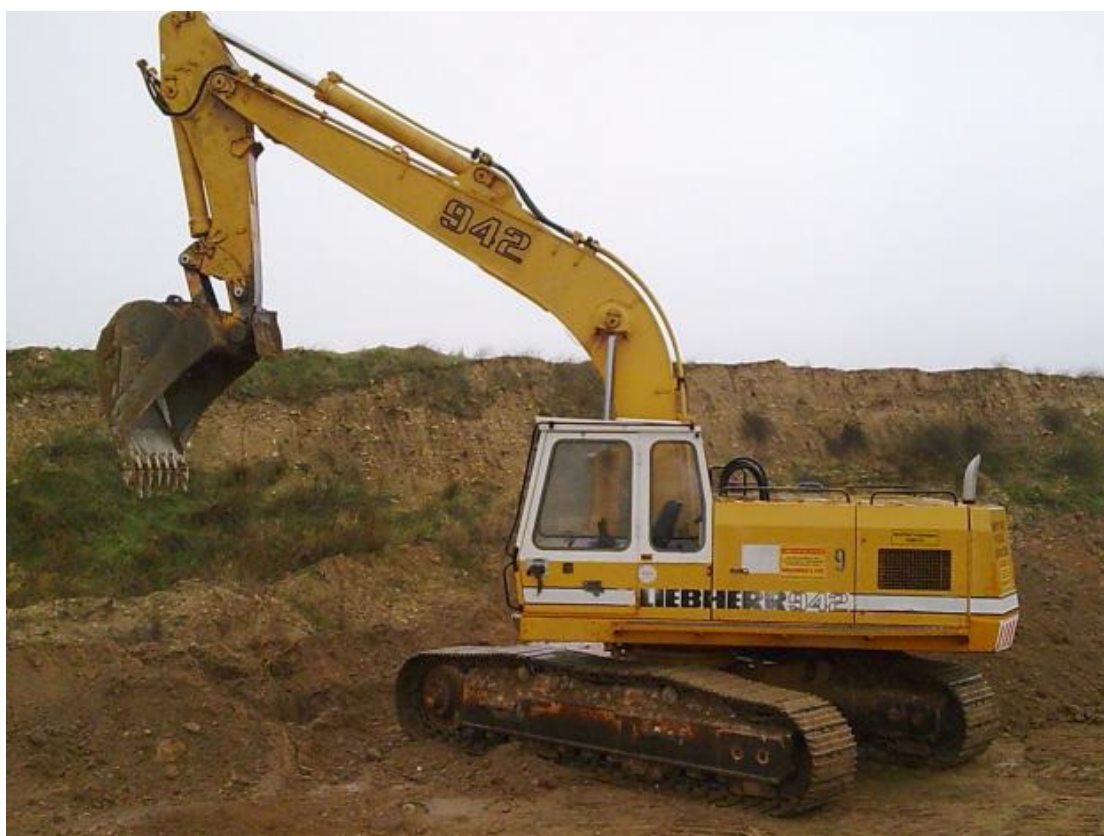
Εικόνα 1 : Ερπυστριοφόρος εκσκαφέας LIEBHERR 942.
