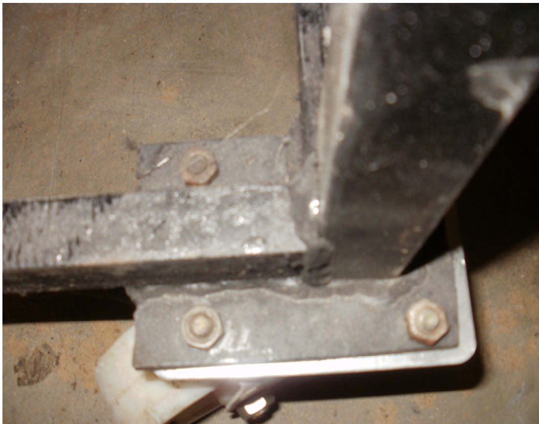
Εικόνα 53 : Συγκόλληση κοιλοδοκών τραπεζιού στηριξης.
