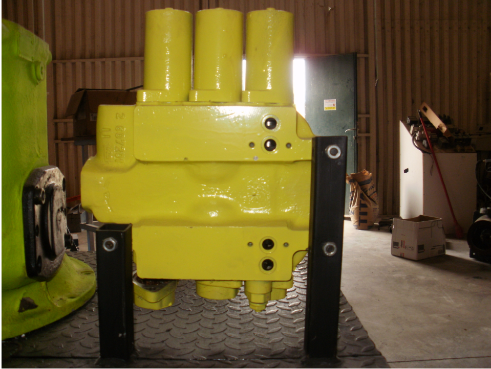
Εικόνα 59 : Χειριστήριο υδραυλικού συστήματος ερπυστριοφόρου εκσκαφέα LIEBHERR 942.
