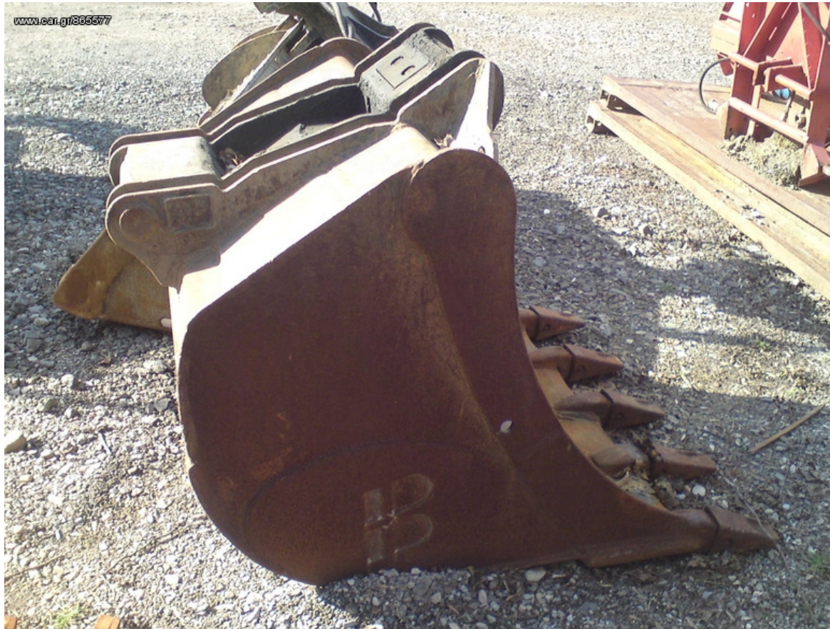
Εικόνα 4 : Κάδος ερπυστριοφόρου εκσκαφέα LIEBHERR 942.
