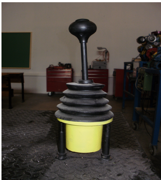
Εικόνα 60 : Χειριστήριο καμπίνας ελέγχου χειρισμού ερπυστριοφόρου εκσκαφέα LIEBHERR 942
