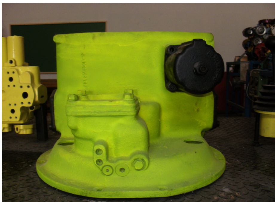
Εικόνα 49 : Κυρίως αντλία ερπυστριοφόρου εκσκαφέα LIEBHERR.
