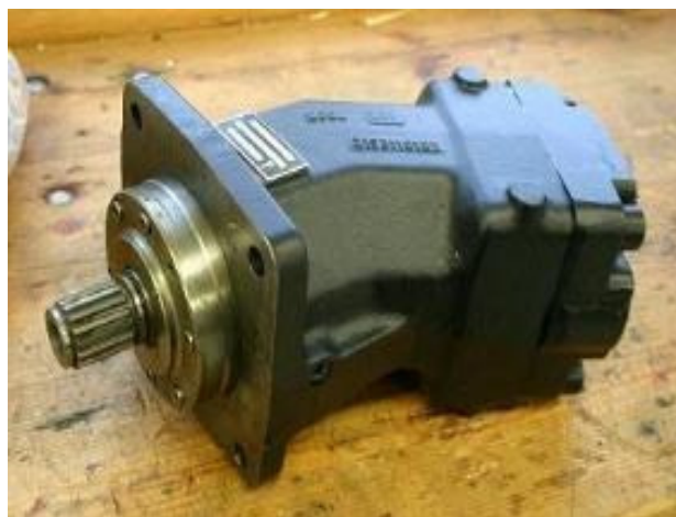
Εικόνα 3 :Υδραυλικό μοτέρ κίνησης ερπυστριοφόρου εκσκαφέα LIEBHERR 942.
