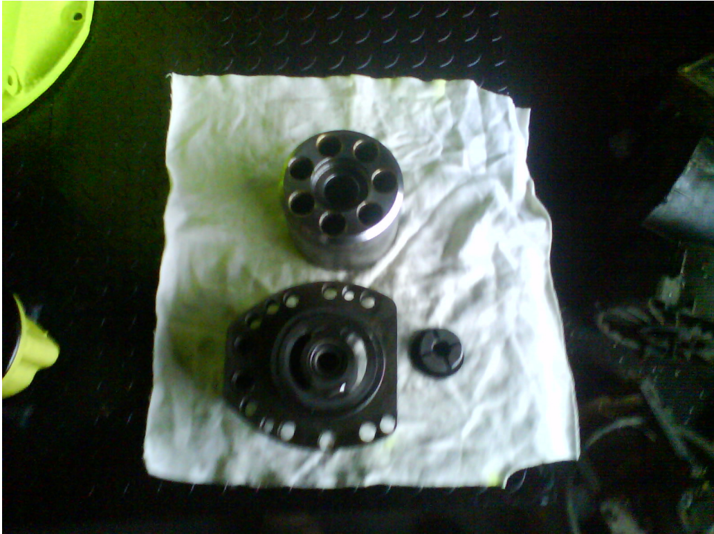
Εικόνα 58 : Εντόστια υδραυλικής αντλίας ερπυστριοφόρου εκσκαφέα LIEBHERR 942.
