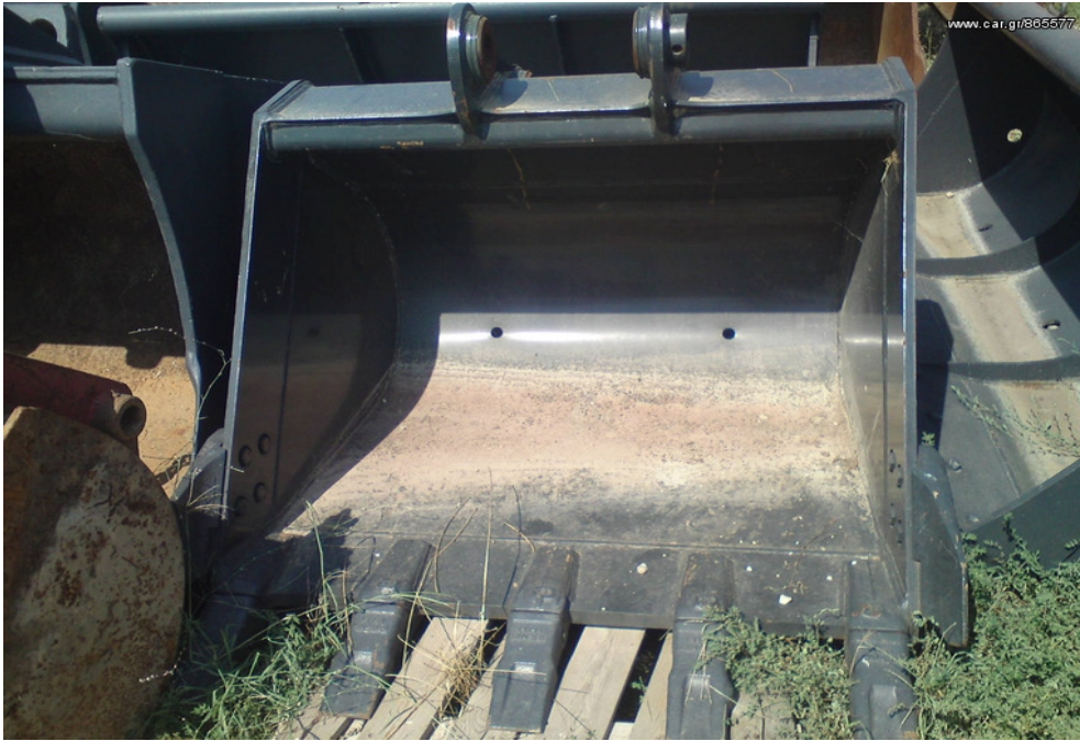
Εικόνα 5 : Κάδος ερπυστριοφόρου εκσκαφέα LIEBHERR 942.
