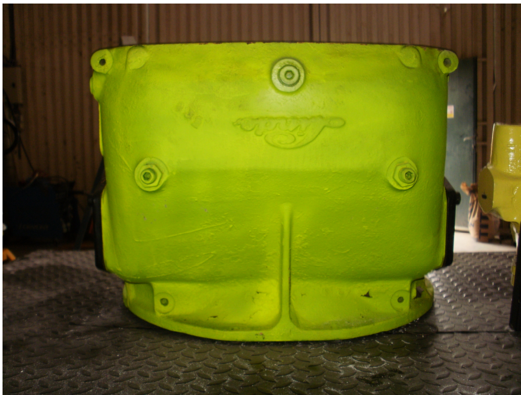
Εικόνα 57 : Κυρίως αντλία ερπυστριοφόρου εκσκαφέα LIEBHERR 942 .
