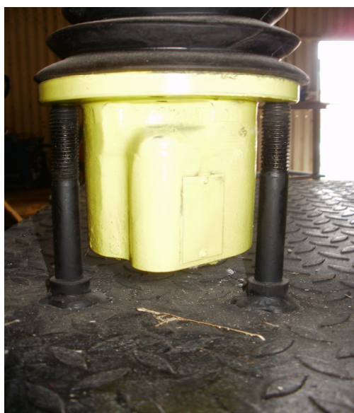
Εικόνα 61 : Βάση στήριξης καμπίνας ελέγχου χειρισμού ερπυστριοφόρου εκσκαφέα LIEBHERR 942.
