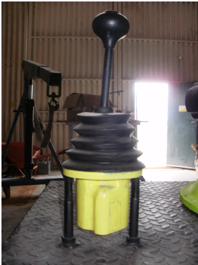
Εικόνα 51 : Χειριστήριο καμπίνας ελέγχου χειρισμού ερπυστριοφόρου εκσκαφέα LIEBHERR 942
