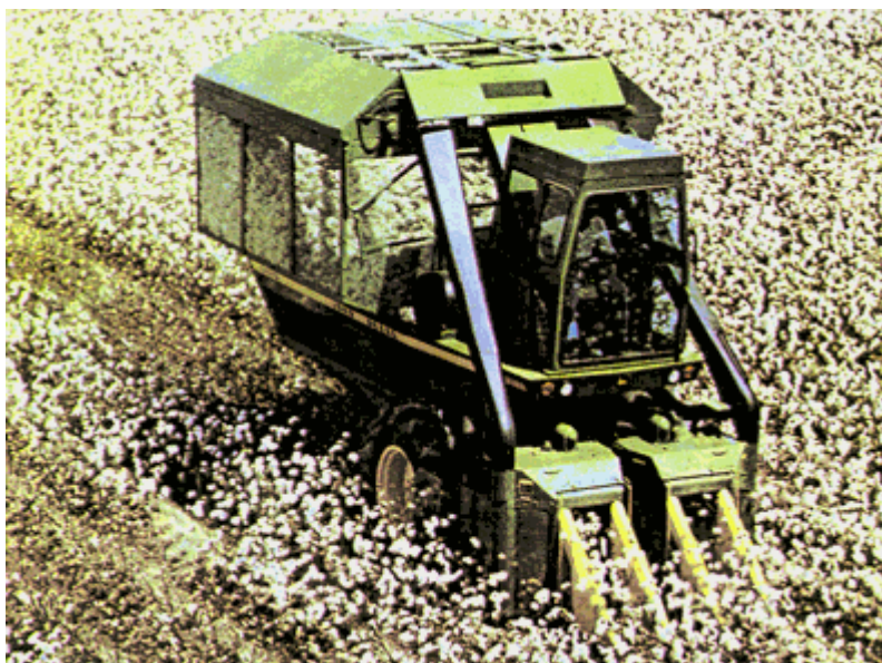
Εικ. 9.4. Βαμβakoσυλλεκτική μηχανή δύο σειρών.
