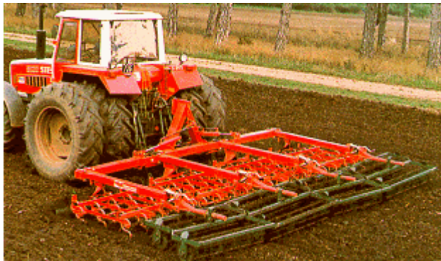
Εικ. 7.3. Καλλιεργητής προετοιμασίας
