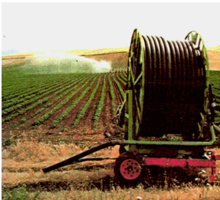
Εικ. 9.2. Αρδευτικό καρούλι με εκτοξευτήρα.
