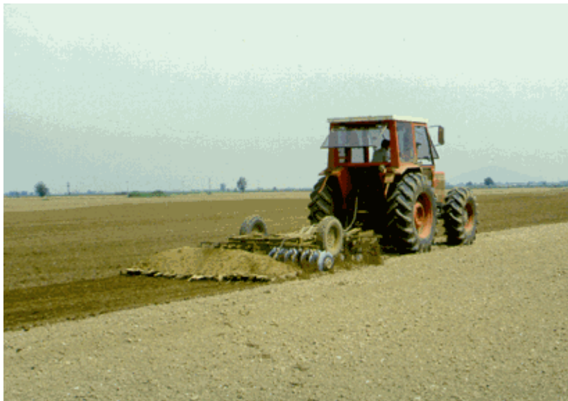
Εικ. 7.4. Δισκοσβάρνα με ξύλινη πλεκτή σβάρνα
