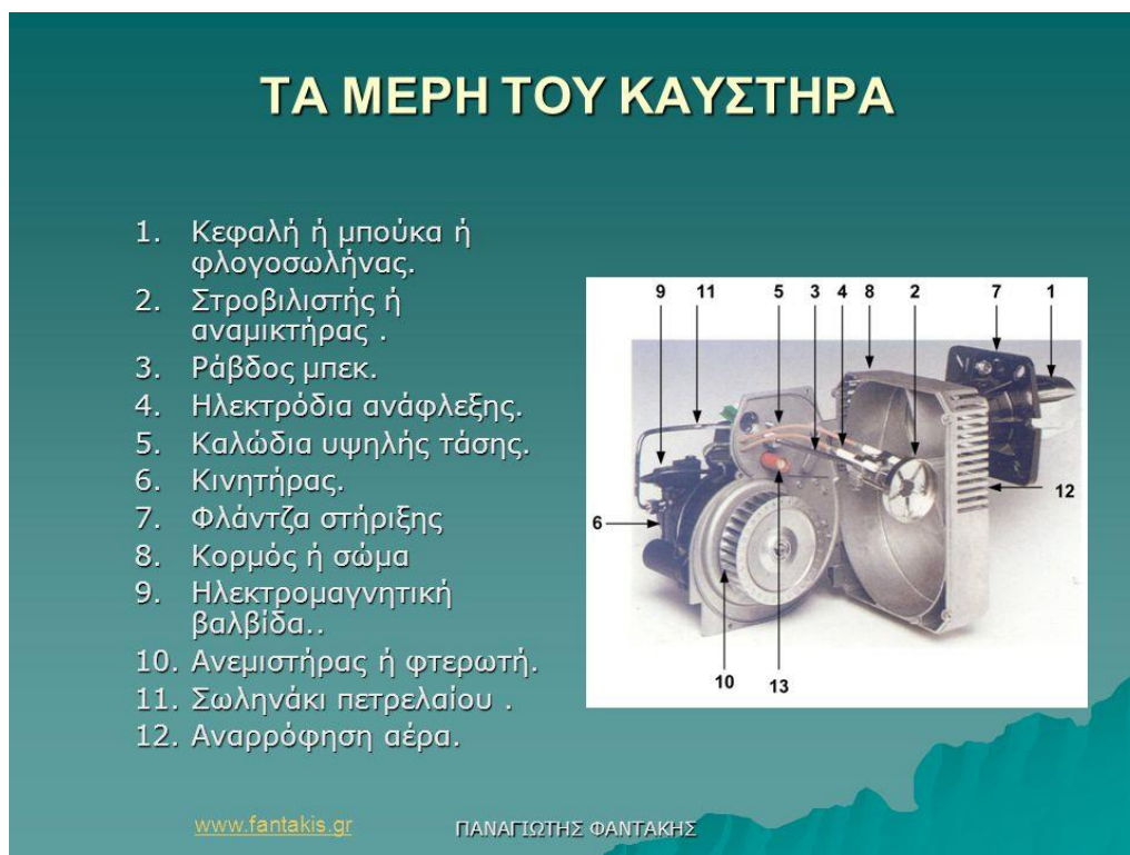
Εικόνα 2.3: Μέρη ενός καυστήρα πετρελαίου (Εταιρεία ΦΑΝΤΑΚΗΣ)
