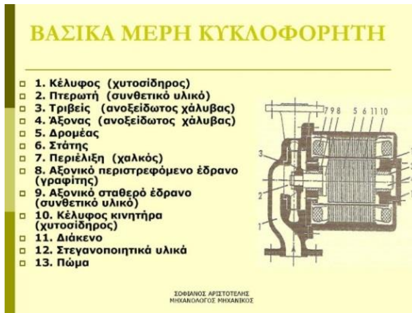
Εικόνα 3.9: Βασικά μέρη κυκλοφορητή (Σοφιανός, 2011)
