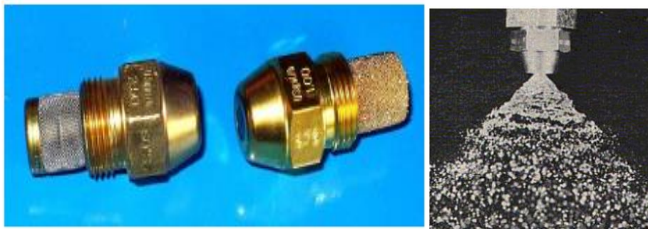
Εικόνα 2.5: Μπεκ και ψεκασμός πετρελαίου στον καυστήρα (Βλαχογιάννης & Καμπούρας, 2014)
