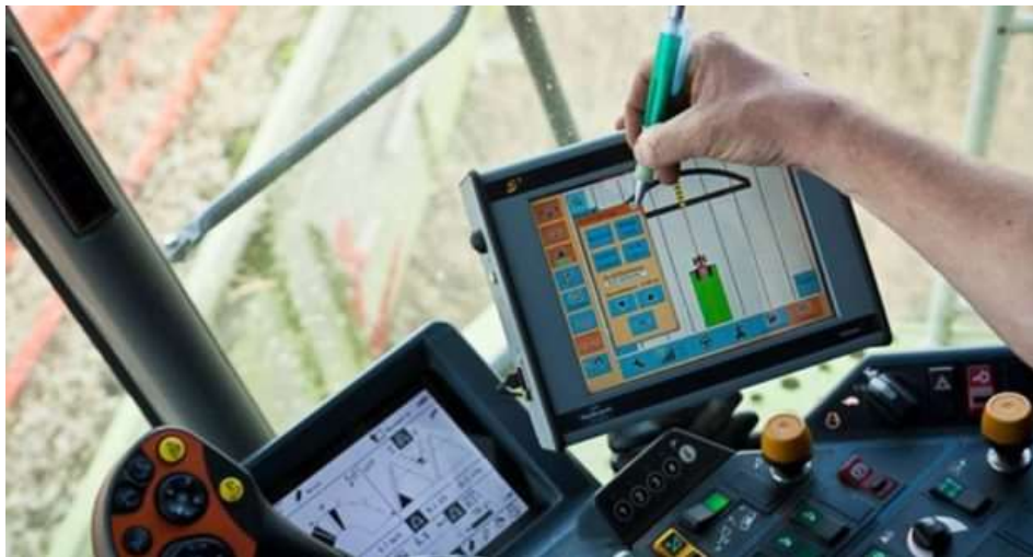
Σχήμα 3.10: Πεδίο χειρισμού τρακτέρ με τεχνολογίες εντοπισμού θέσης
