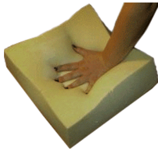
Εικόνα 1. 4 Παροδική ή Ελαστική Παραμόρφωση
